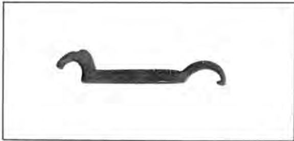
EXHAUST RING and STEERING NUT WRENCH Tool No. 90890-01268 CLE POUR ECROU ANNULAIRE D'ÉCHAP- PEMENT ET POUR ECROU DE DIRECTION Outil No. 90890-01268
