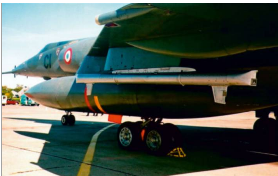
Pod de brouillage d'autoprotection Barax NG sous l'aile du Mirage IV. C'est dans cette configuration que le Mirage IVP fut utilisé au-dessus de l'Irak en 2003 en appui des inspections de l'ONU. (P. Wodka-Gallien)
