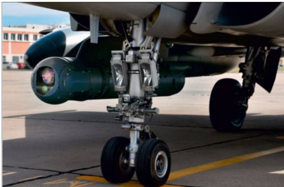
Pour le jeu des Sept différences ! L'atterrisseur avant du Rafale Air, ci-dessus (Dassault Aviation/A. Bonfort), et du Rafale Marine, ci-dessous (Dassault Aviation/S. Randé), une fois la barre de traction abaissée sur la catapulte (le hold-back n'appartient pas à l'avion). La barre de contreventement est bien visible.
