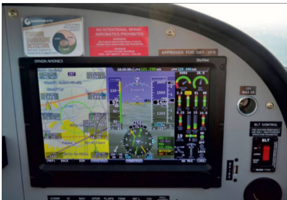
Un écran, trois affichages (carte, instruments de vol, paramètres moteurs). On note la température d'huile élevée, conséquence de la réchauffe carburateur maintenue, par erreur, après une remise de gaz. (F. Marsaly)
