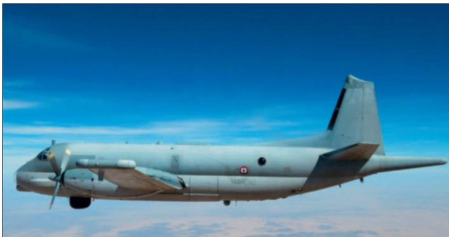
Un ATL2 de la Marine Nationale. On distingue en bout d'aile les pods de soutien électronique. En enrichissant la connaissance de la situation tactique, la GE permet d'orienter la conduite de la mission. (Marine Nationale)
