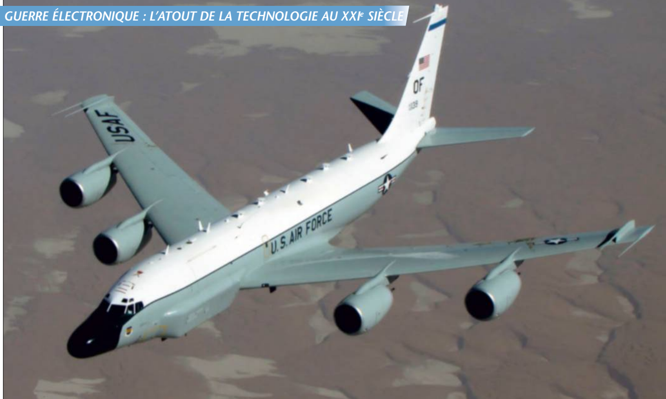
Le CR-135 Rivet Joint est l'instrument majeur de collecte de renseignements d'origine électromagnétique de l'US Air Force. La flotte comprend une douzaine d'appareils Sigint de ce type ; elle est basée à Offutt Air Force Base dans le Nebraska. (Usaf)
