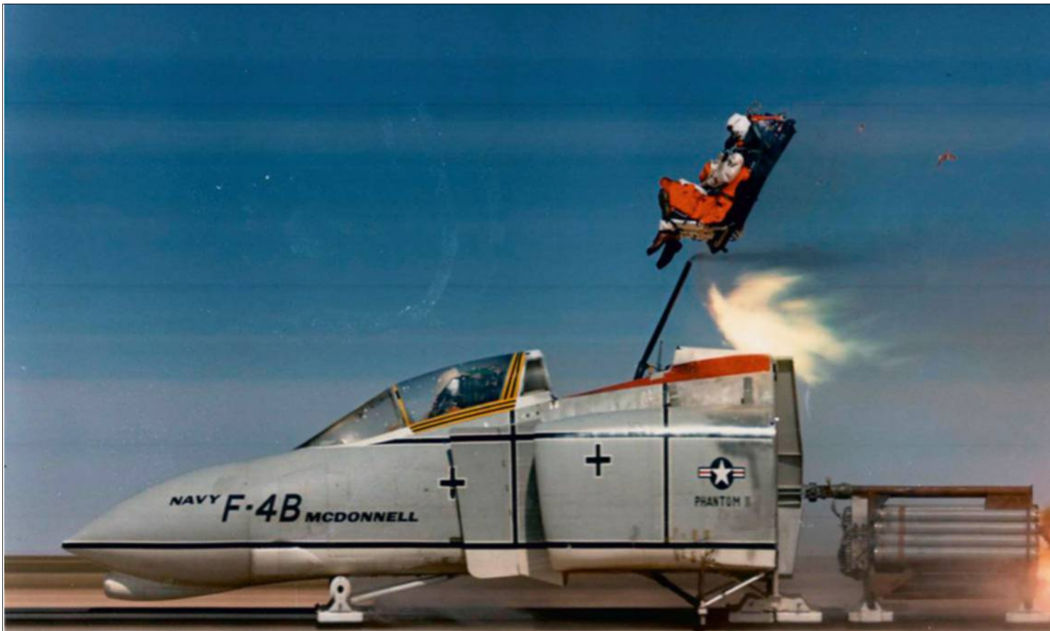
Essai d'éjection d'un mannequin depuis un traîneau reproduisant la pointe avant du fuselage d'un McDonnell Douglas F-4B. (DR)
