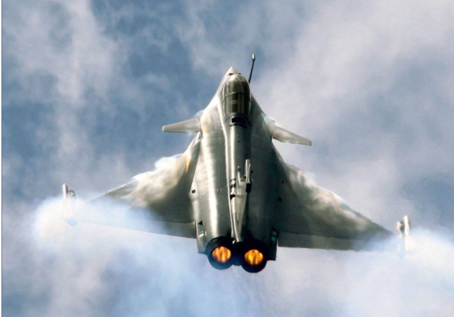
La fumée met en évidence les tourbillons sur la voilure du Rafale, qui dynamisent la couche limite en favorisant la portance aux grands angles d'attaque. (Dassault Aviation/Sébastien Mousty)
