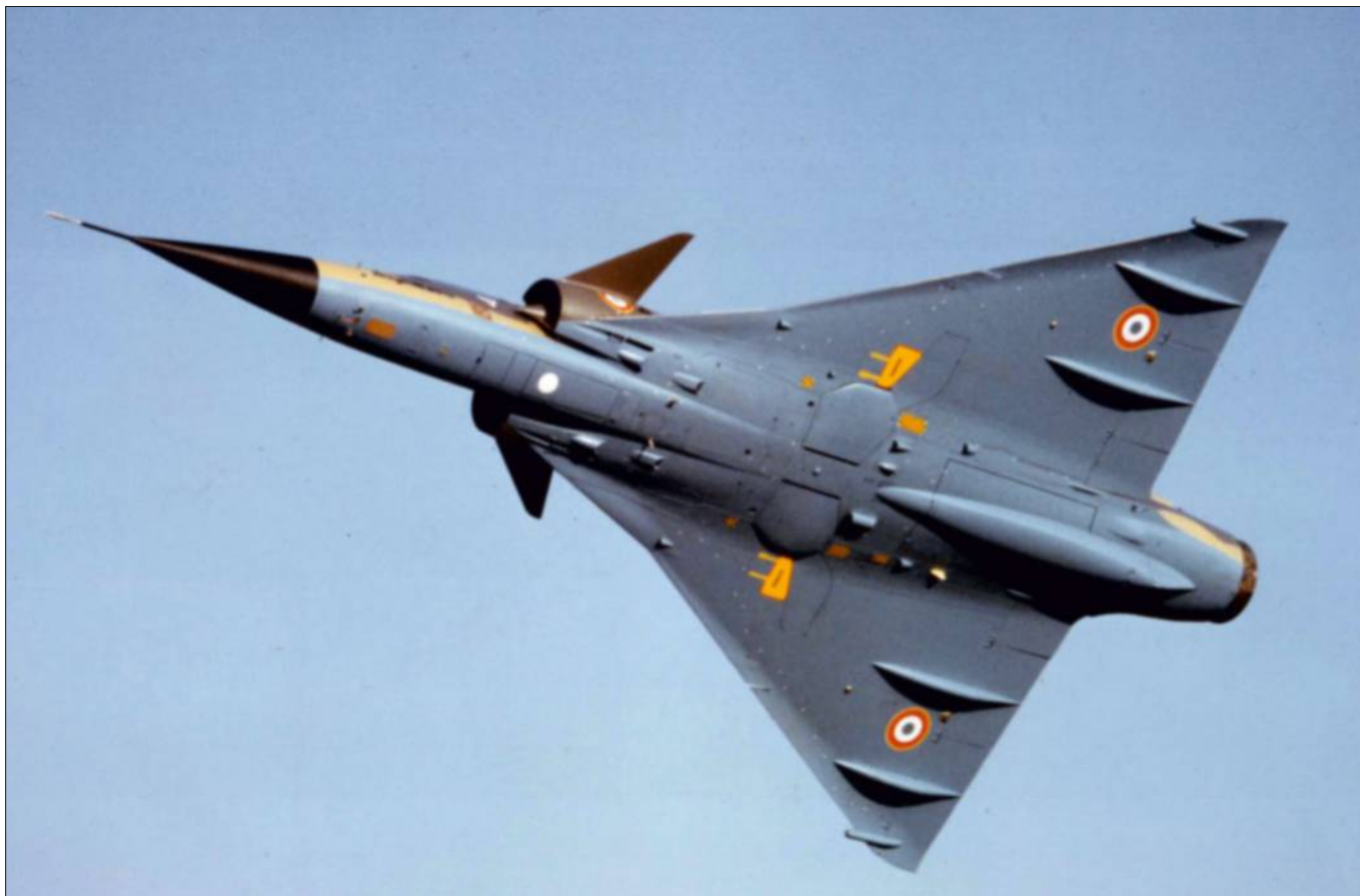
Vue du Mirage III NG, où apparaissent magnifiquement l'empennage canard, les apex du bord d'attaque, mais aussi les bords d'attaque vrillés propres aux Mirage III pour ralentir la vitesse de décrochage aux grands angles d'incidence. (Dassault Aviation)
