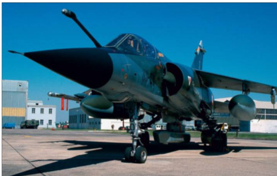
Mirage F1CR de l'armée de l'Air porteur d'une nacelle Elint ASTAC (Analyseur de signaux tactiques). (P. Wodka-Gallien)
