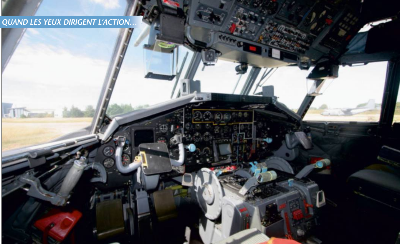
Le poste de pilotage du Transall rénové : un mélange de classicisme et de modernité, avec les deux HUD des pilotes. (Frédéric Lert)
