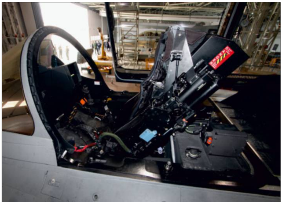
Le siège éjectable MkF16F du Rafale, dont la forte inclinaison permet au pilote de mieux supporter les accélérations. (Frédéric Lert)
