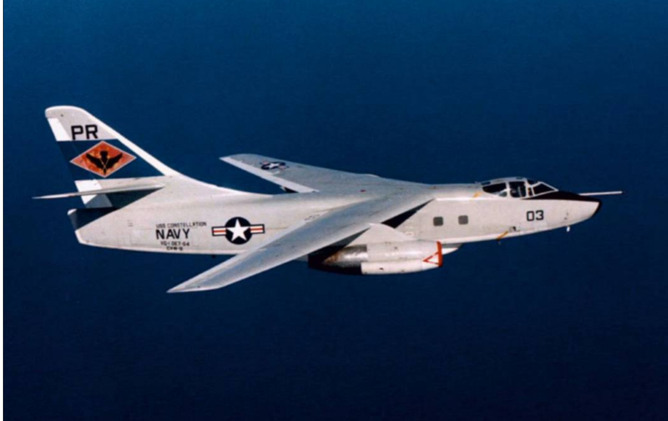
Douglas EA-3B de l'US Navy. Destiné aux missions de renseignements au profit de l'aviation embarquée, il intervenait en particulier dans la surveillance de l'activité radio-électronique au large de la Chine ou de l'Europe du Sud. (Us Navy)
