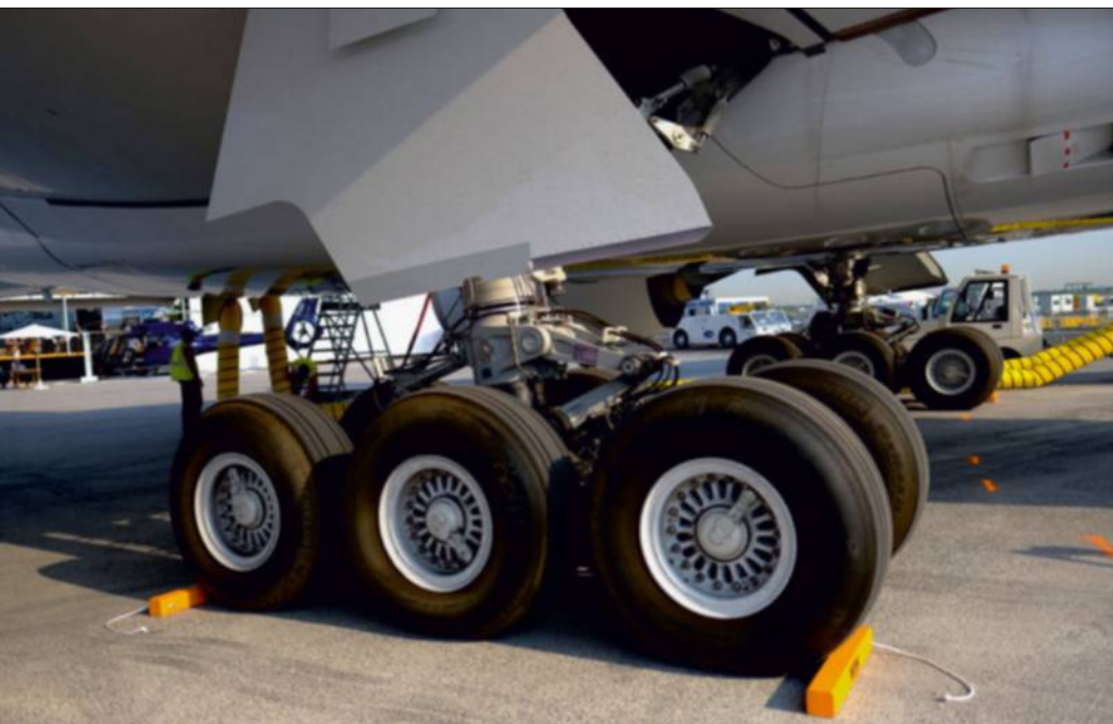
Les pneus nécessitent une surveillance toute particulière, ici ceux de l'Airbus A350-1000. (Cyril Abad/CAPA Pictures/Safran)
