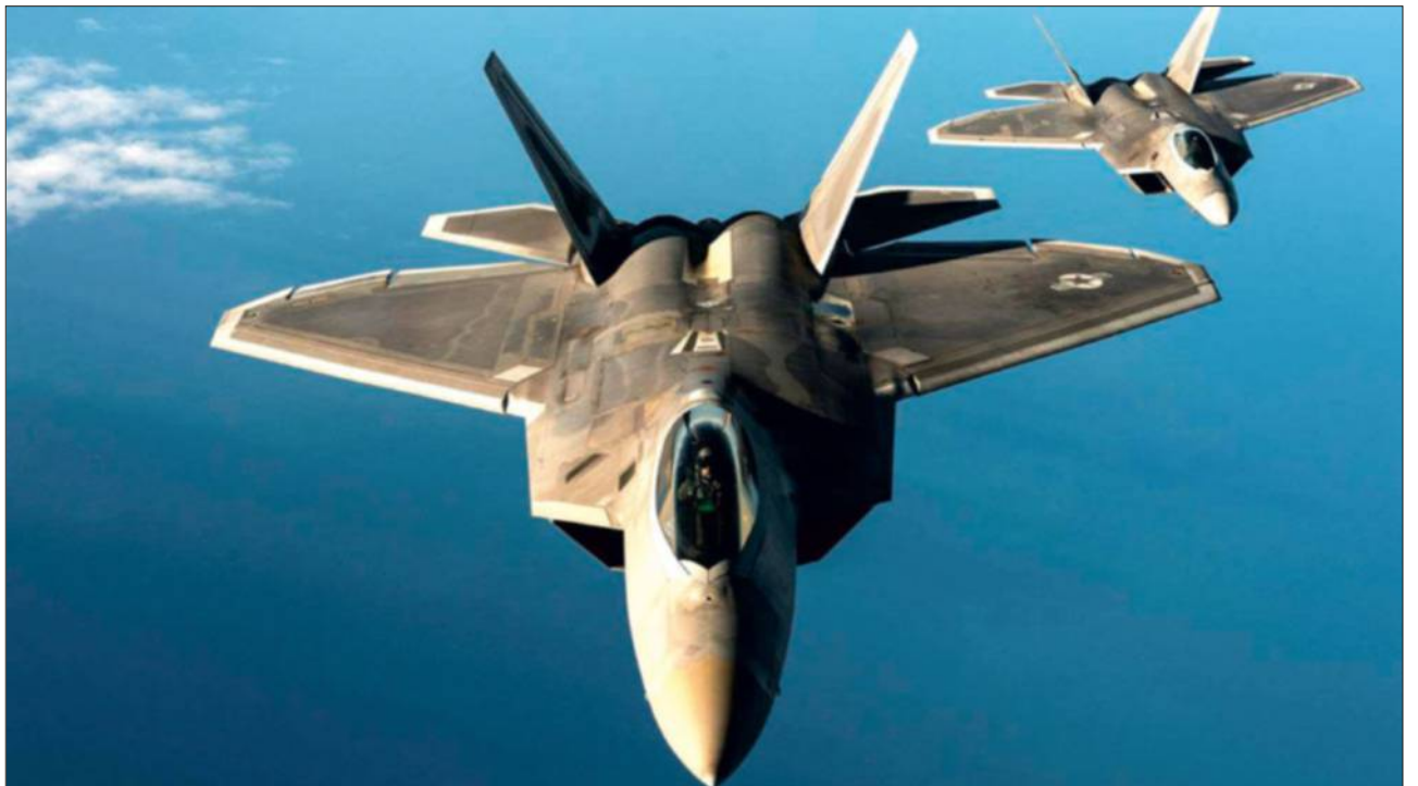
Les formes du chasseur F-22 permettent de réduire sa signature radar. (Lockheed Martin)
