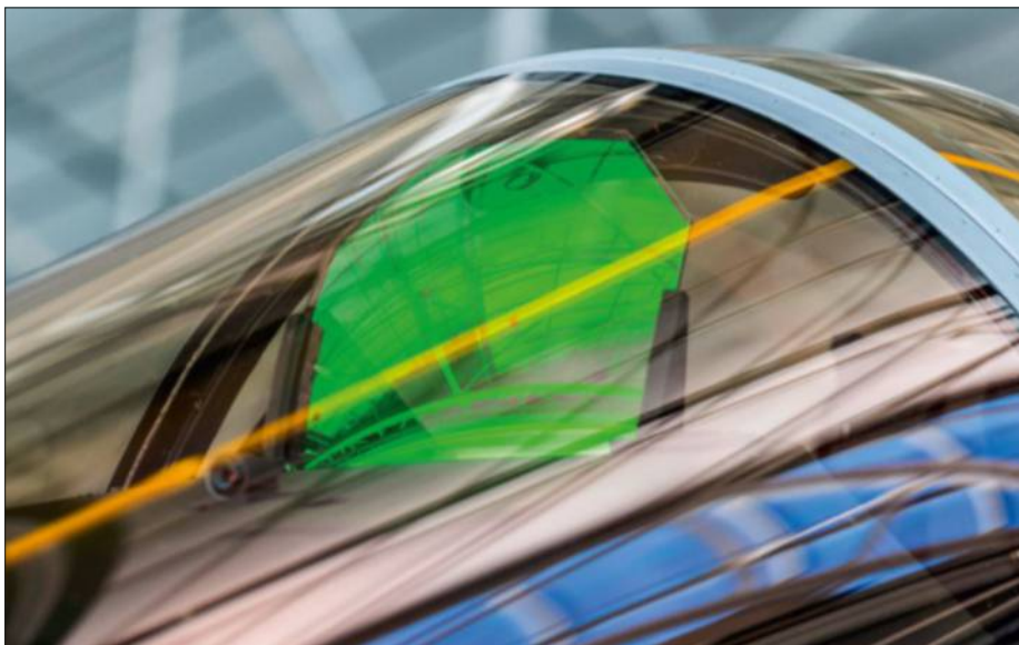
Le HUD des chasseurs modernes est de plus en plus large. Le chant du cygne avant le remplacement total par les affichages sur les visières ? (Dassault Aviation - S. Randé)
