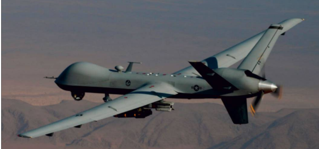
Reaper armé de bombes Paveway et de missiles Hellfire. Cette configuration développée en vue de limiter les engagements de troupes au sol répond aux nouveaux impératifs opérationnels imposés par les guerres asymétriques consécutives aux attaques terroristes du 11-Septembre 2001. (Usaf)
