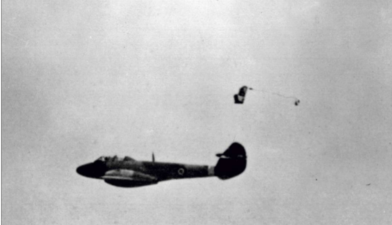
Le 24 juillet 1946, Bernard Lynch, employé de Martin Baker, se porte volontaire pour un essai en conditions réelles à partir d'un Gloster Meteor 3. Il totalisera à la fin de sa carrière une trentaine d'éjections ! (Martin Baker)
