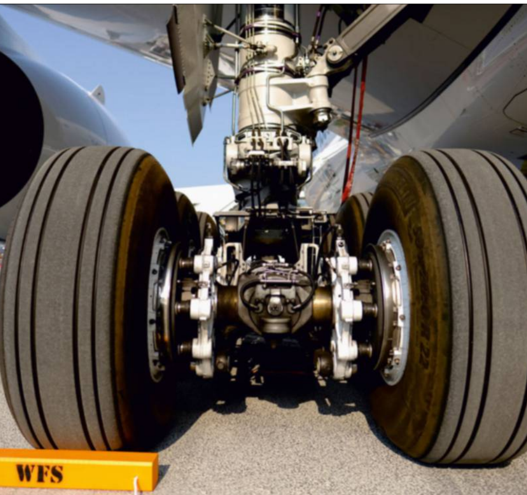
Les pneus sont une composante essentielle du train d'atterrissage. Les moyeux contiennent les freins carbone. (Cyril Abad/CAPA Pictures/Safran)
