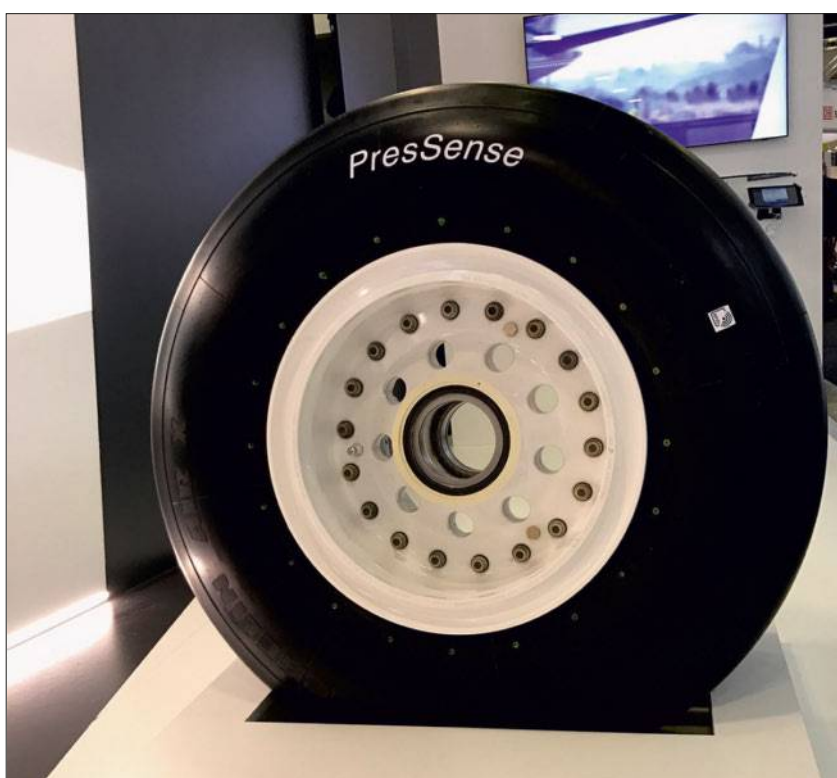
Avec PresSense, le pneu envoie directement les informations techniques le concernant, pour faciliter sa maintenance. (Michelin)
