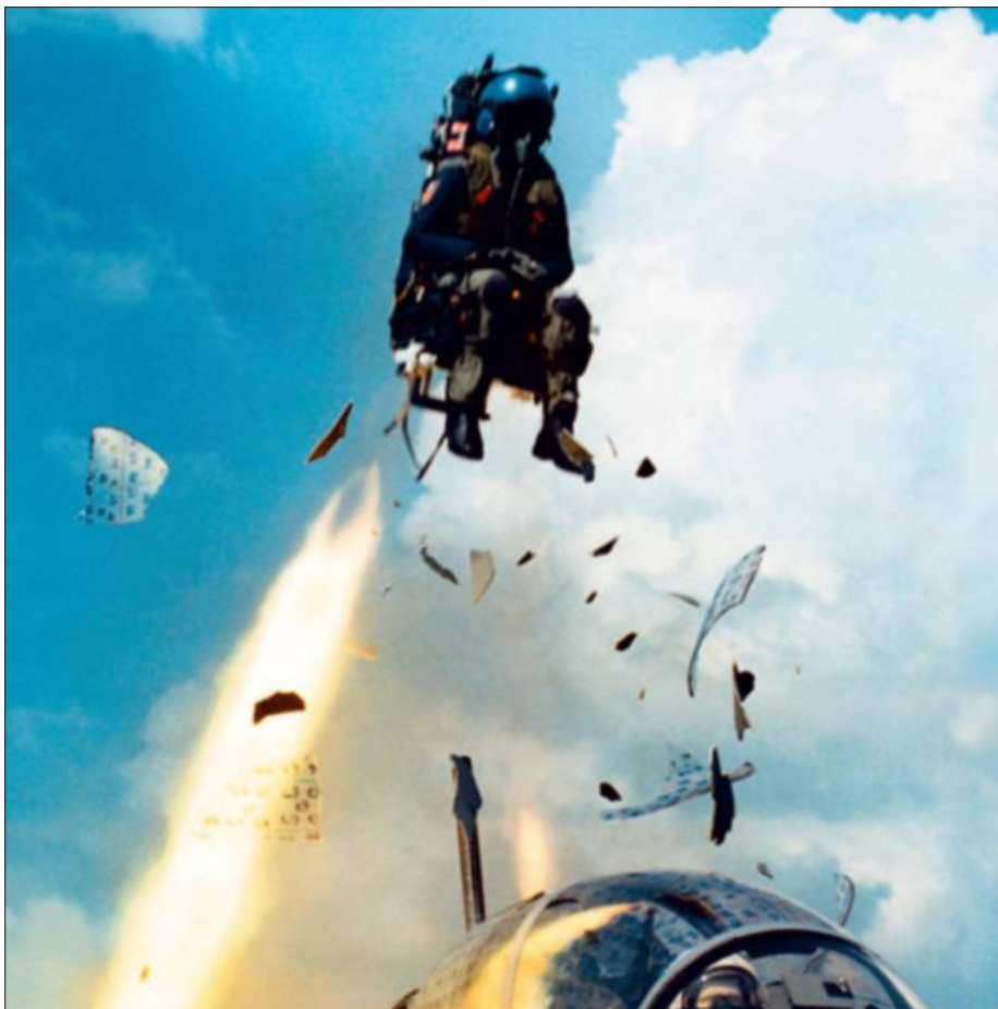
Une des difficultés dans l'éjection est de franchir l'obstacle de la verrière. Quand celle-ci n'est pas larguée, il faut passer à travers... (DR)
