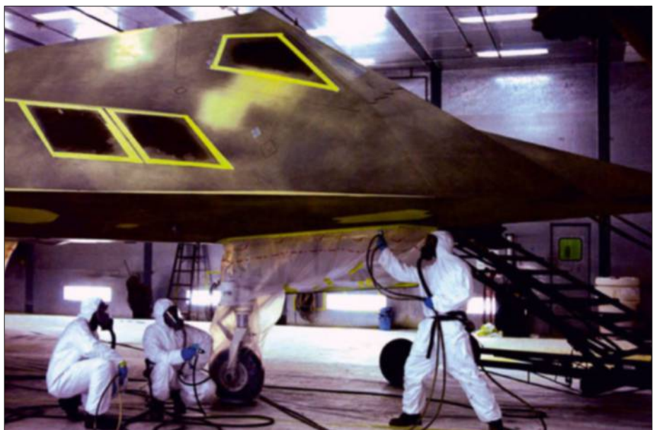
Le Lockheed F-117, dont les formes furent étudiées pour le rendre discret face aux radars. Sur la photo ci-dessous, les techniciens apposent le revêtement spécial qui concourait à piéger les ondes des radars. (Usaf)
