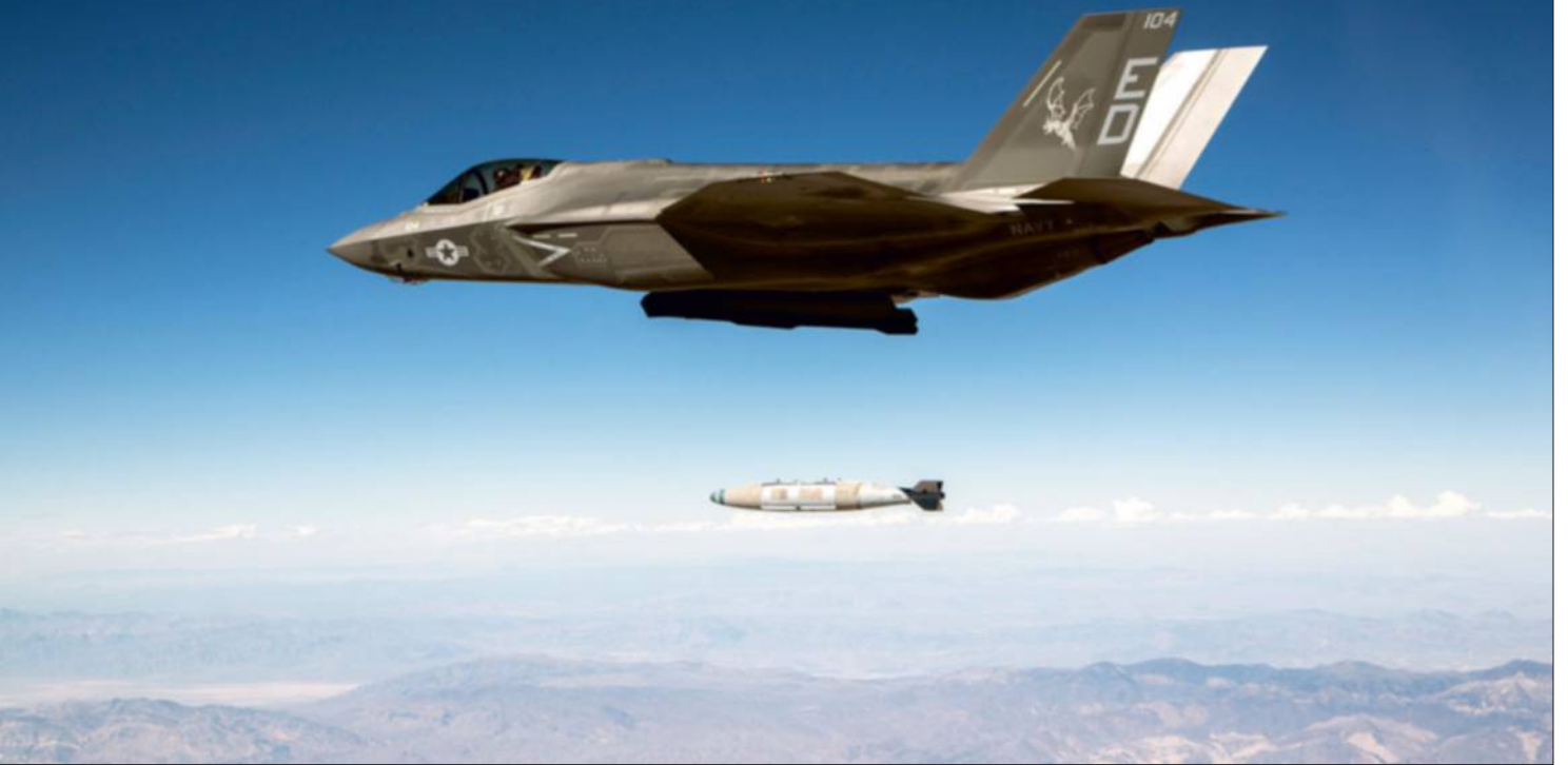
Mettre les charges en soute, comme ici avec le F-35, permet d'assurer la discrétion face aux radars. (Lockheed Martin)
