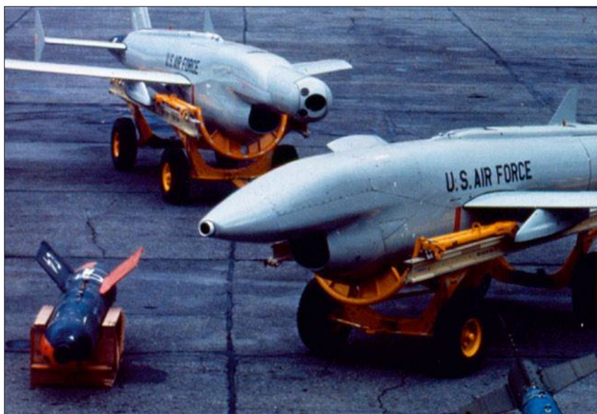
Drones BQM-34 Firebee modifiés au début des années 1970 pour l'emport d'armes air-sol de précision. On distingue, sur le chariot de gauche, la bombe planante téléguidée Studdy Hobo. (Usaf)
