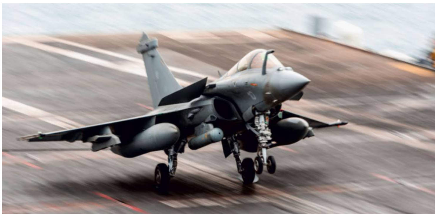
Le pneu est poussé au maximum de sa résistance lors de l'appontage. Ici un Rafale Marine. (Dassault Aviation/Alex Paringaux)
