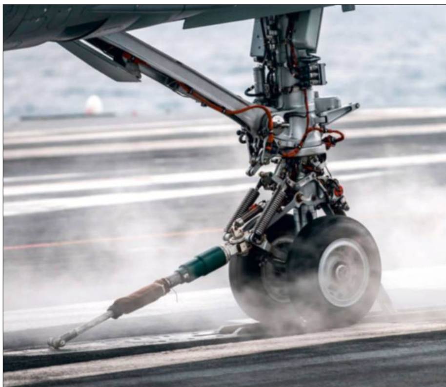
Pour le jeu des Sept différences ! L'atterrisseur avant du Rafale Air, ci-dessus (Dassault Aviation/A. Bonfort), et du Rafale Marine, ci-dessous (Dassault Aviation/S. Randé), une fois la barre de traction abaissée sur la catapulte (le hold-back n'appartient pas à l'avion). La barre de contreventement est bien visible.
