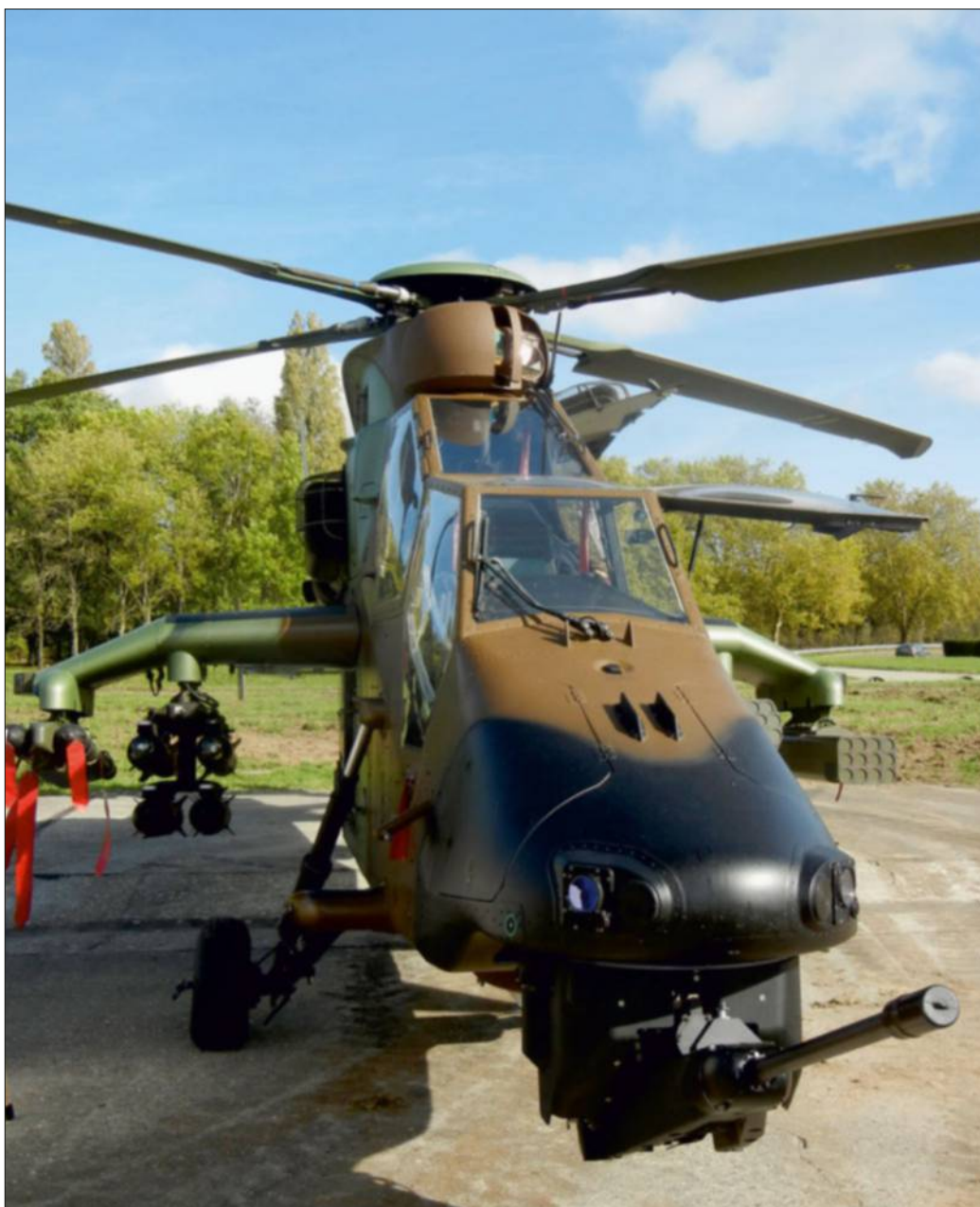
L'hélicoptère de combat Tigre de l'ALAT dispose d'un ensemble d'autoprotection très complet et totalement intégré. On distingue, sur la pointe avant, les antennes du détecteur de radar et les capteurs infrarouges destinés à repérer le tir d'un missile. (P. Wodka-Gallien)
