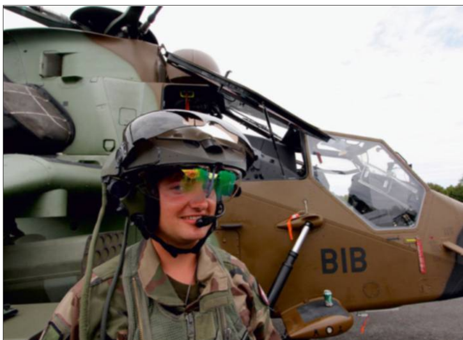
Le casque Topowl de Thales, ici au service du Tigre, avec la projection des informations sur la visière claire. (Frédéric Lert)
