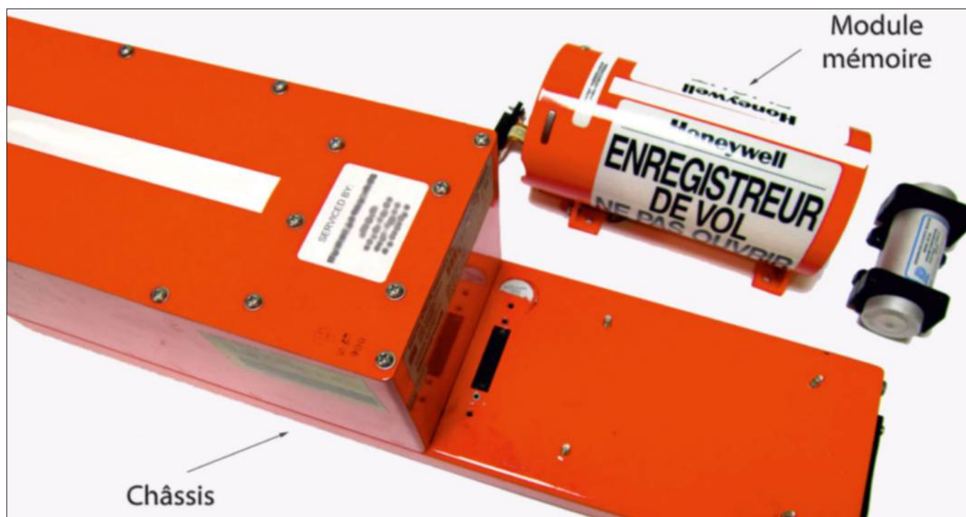
L'enregistreur des paramètres (ou FDR), qui renseigne sur les paramètres du vol. (BEA)
