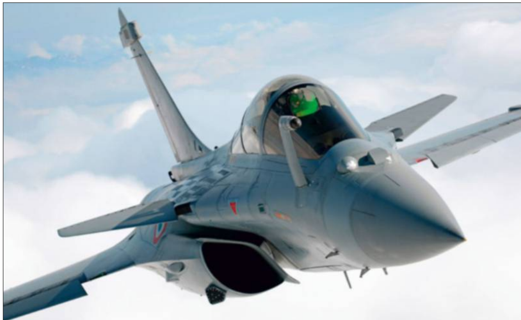
Les canards et les entrées d'air semi-ventrales du Rafale : une recette aérodynamique raffinée. (Safran/Anthony Pecchi)
