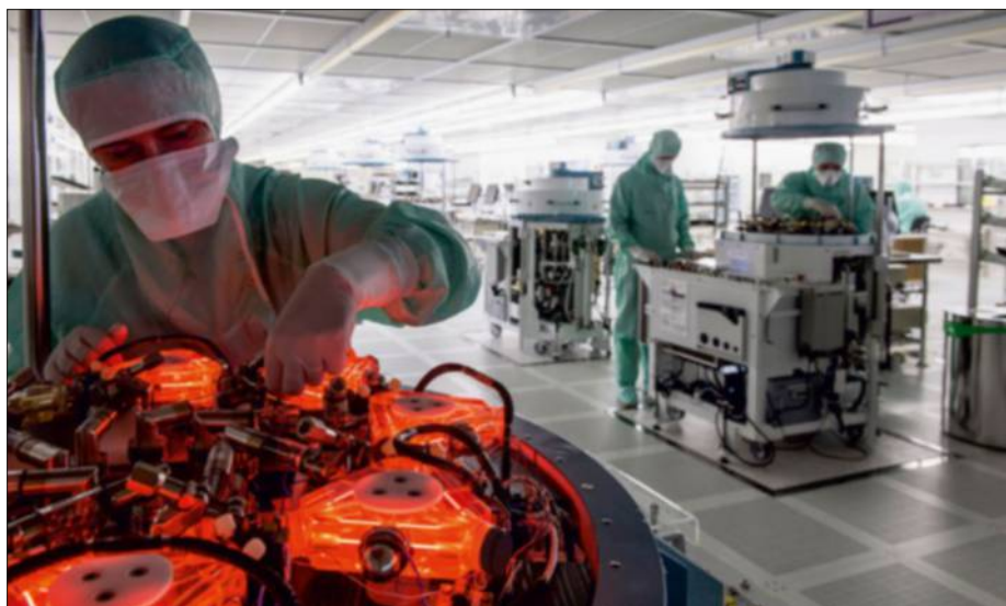
Au cœur d'une centrale inertielle de navigation, le gyroscope – ici en rouge. (Philippe Stroppa/Safran)
