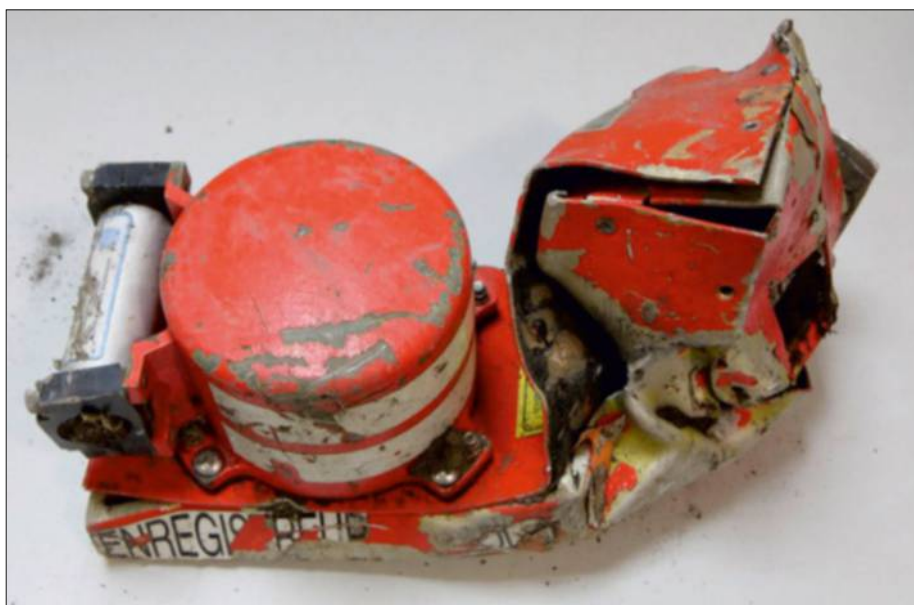
L'enregistreur de cockpit (CVR) du vol Germanwings du 24 mars 2015 : un témoignage de la violence du choc. (DR)
