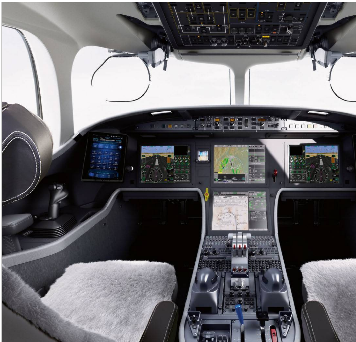
Luxe, calme et... sécurité : le poste de pilotage du Falcon 8X est dominé par des écrans à cristaux liquides et les deux HUD à champ large. (Dassault Aviation)
