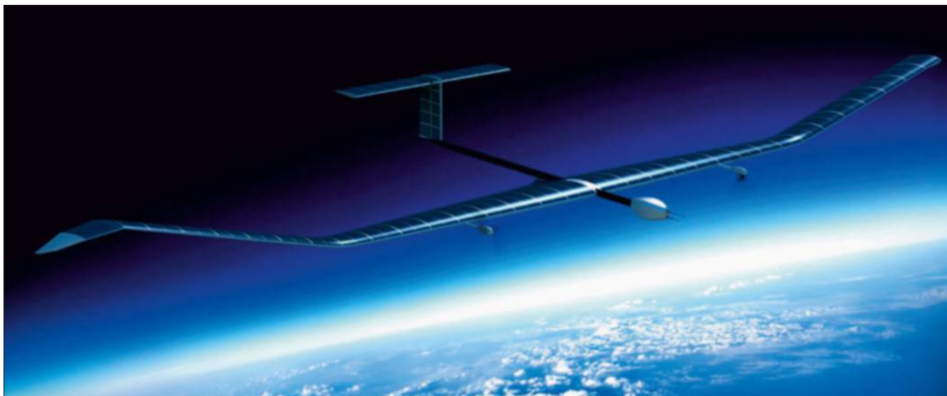
Vue d'artiste du projet Airbus Zephyr S, un drone géant. Sa propulsion solaire lui permettra de rester plusieurs mois dans la stratosphère pour des missions de renseignements ou de télécommunications. Un démonstrateur a réussi à tenir en l'air 25 jours entre juillet et août 2018. (Airbus)
