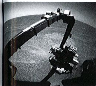
Bras articulé du robot Opportunity envoyé sur la planète Mars. À son extrémité, se trouvent des instruments de mesures.
