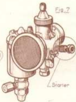
TYPE VELOMOTEUR Arrivée dessous Raccord banjo
