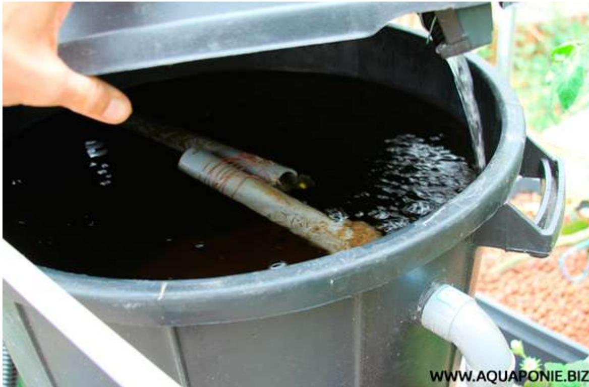
Ce filtre est intéressant car il permet de récupérer facilement les sédiments en un simple tour de vanne.
