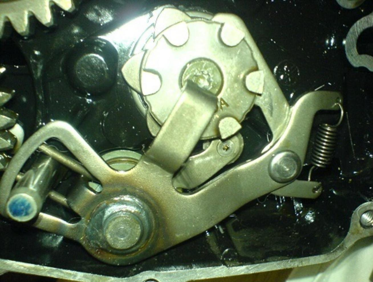
Avant la dépose de l'axe on visualise bien les emplacements des pièces et ressorts
