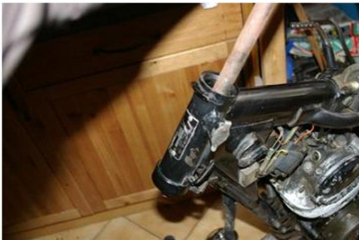
**En faisant levier avec 2 tournevis, dégagez la coupelle du "T" inférieur.
