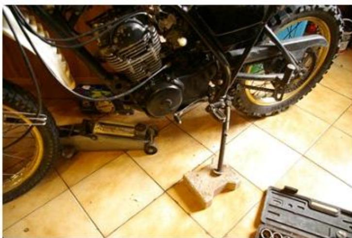
**Avec un cric placé sous le moteur, soulevez l'avant de la moto.**
