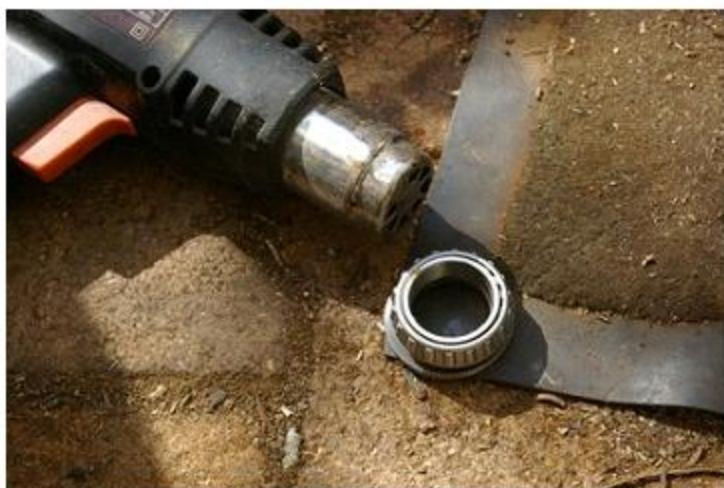
**Emboitez le roulement sur l'axe à l'aide d'un tube de bon diamètre.
