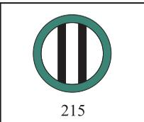
Image *signal final de réduction de vitesse pour trains pendulaires, circulant selon la catégorie de train correspondante*
