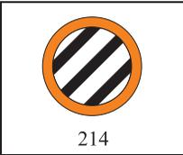
Image *signal d'exécution de réduction de vitesse pour trains pendulaires, circulant selon la catégorie de train correspondante*
