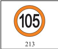
Image *signal avancé de réduction de vitesse pour trains pendulaires, circulant selon la catégorie de train correspondante*
