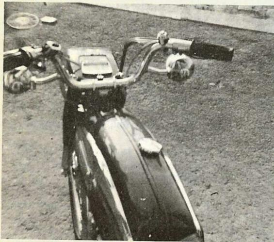
Vue du poste de pilotage. Voyez le compteur incorporé au phare, les commandes « tout au guidon » et les clignotants solidement ancrés.
