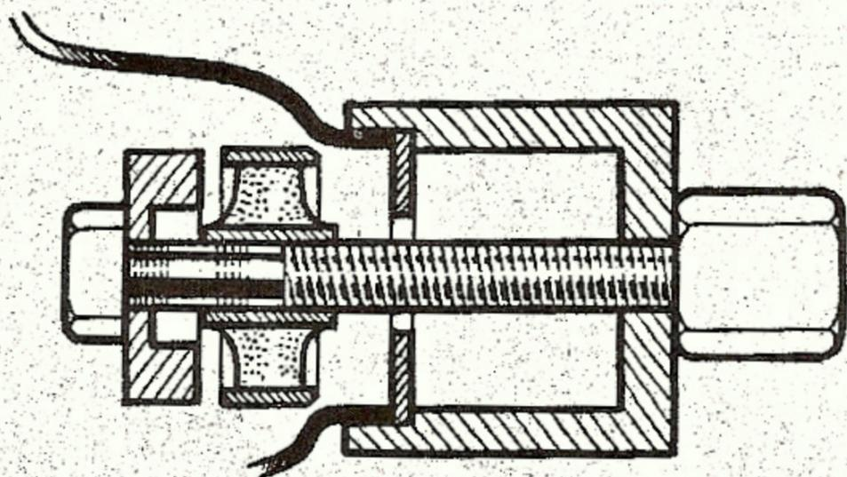
Engager le FLEXIBLOC côté chanfrein. Placer la rondelle plate à l'intérieur de la douille afin qu'elle serve de butée pour limiter l'emmanchement du FLEXIBLOC à l'aplomb du bossage.
