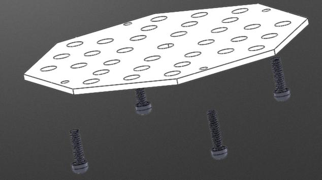
Fixation des 4 écrous borgnes sur les tiges filetées et sur le support de jeu
