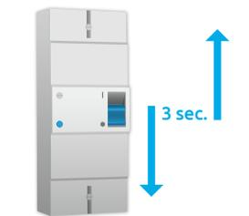
Positionnez le disjoncteur en position **O**, attendez 3 secondes et remettez le disjoncteur en position **I**.
