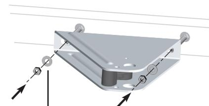
La rondelle (7) fournie doit être montée impérativement.
