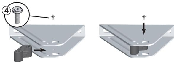
**⚠ Pour une bonne utilisation du déverrouillage, veuillez respecter le sens de montage indiqué sur le schéma. Ne pas monter la vis par en dessous.**
