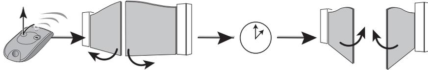
Il est possible de maintenir le portail en position ouverte par un appui bref sur la touche de la télécommande durant la temporisation.
