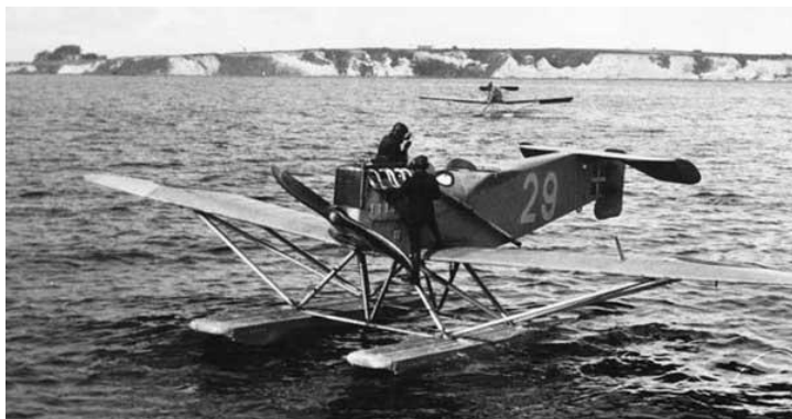
Hansa Brandenburg W29, début 1918 ; notez l'étonnante position de la dérive, sous le plan fixe.
