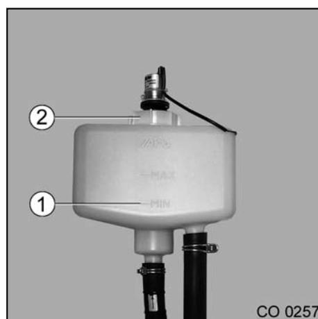
Photo 12-2 Réservoir de compensation pour liquide caloporteur
