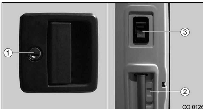
Photo 6-11 Système de serrure extérieur | intérieur
