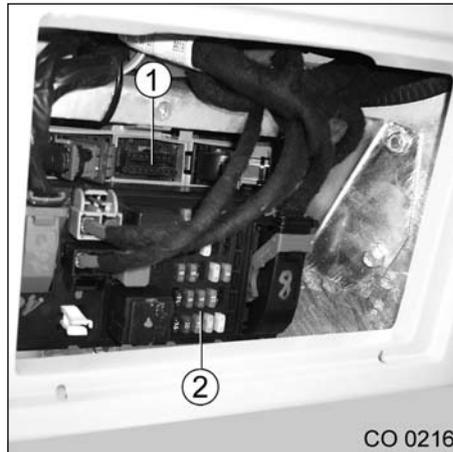
Photo 7-29 Coffret à fusibles sur un Iveco
