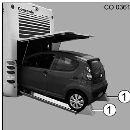
Photo 3-18 Sabots de serrage, voiture parfaitement rangée
