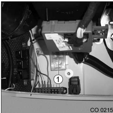
Photo 7-25 Fusible principal du tableau de bord sur un Iveco
