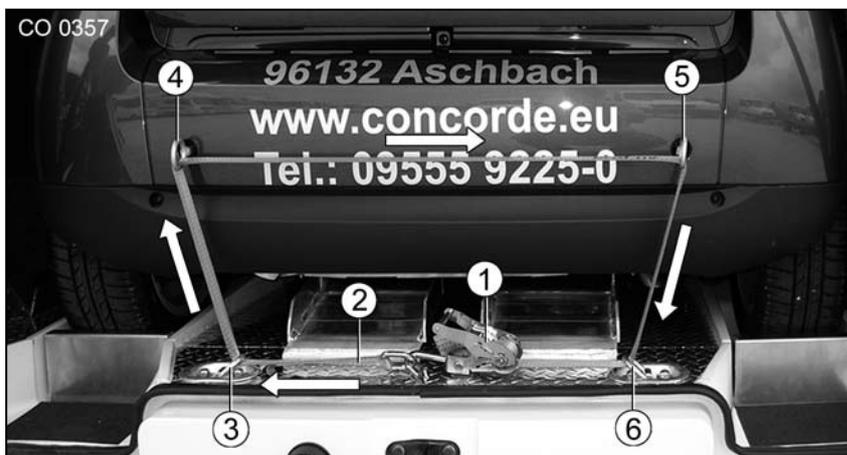
Photo 3-15 Sangles de serrage à l'arrière de la voiture
