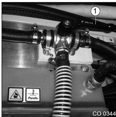
Photo 10-5 Valve d'arrêt, ouverte
