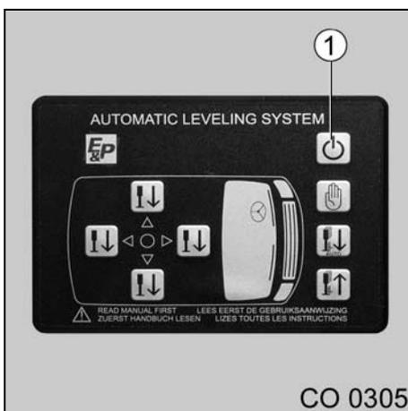
Photo 5-4 Organe de commande pour actionner les béquilles
