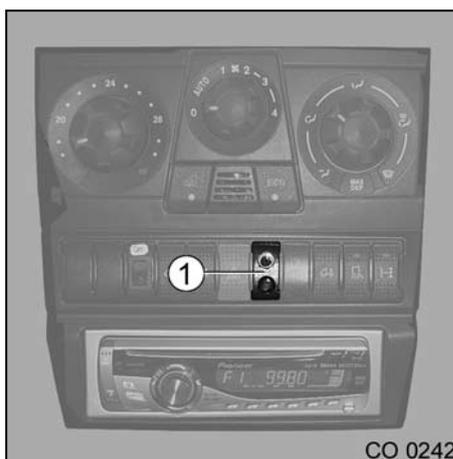
Photo 10–32 Bouton-poussoir et témoin DEL du système d'alarme (exemple)
