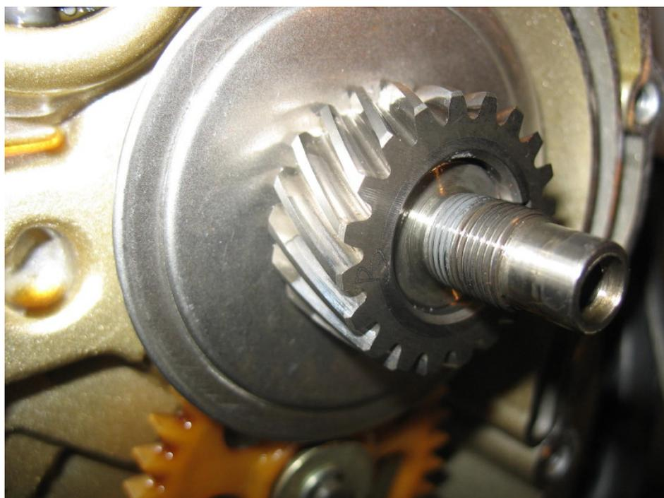
Déposer le filtre rotatif, ici aussi, faire bien attention au sens de montage car les vues du manuel ne sont pas assez précises.
