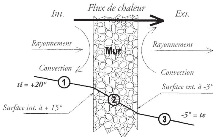
Le mur est à une température intermédiaire entre  $t_i$  et  $t_e$ .
