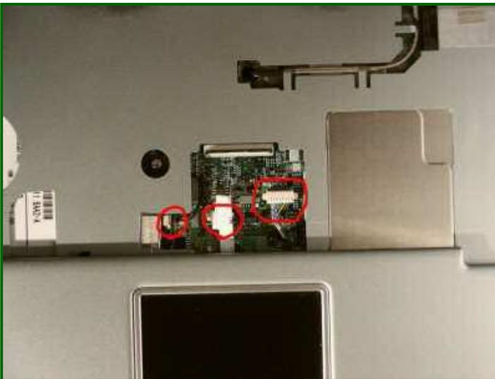
Avant d'ouvrir le boîtier, vous pouvez débrancher les trois connecteurs au dessus du touchpad, mais il faut des petits doigts. Sinon voir l'étape suivante.
