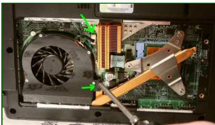
Dévisser le ventilateur (deux vis) et débrancher la prise. Le support du ventilateur bascule simplement en tirant dessus.
