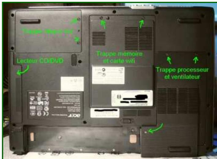
Retirez les trois vis de la trappe d'accès au ventilateur, il faudra forcer très légèrement (en faisant levier avec un couteau par exemple) car les trappes sont clipsées.
