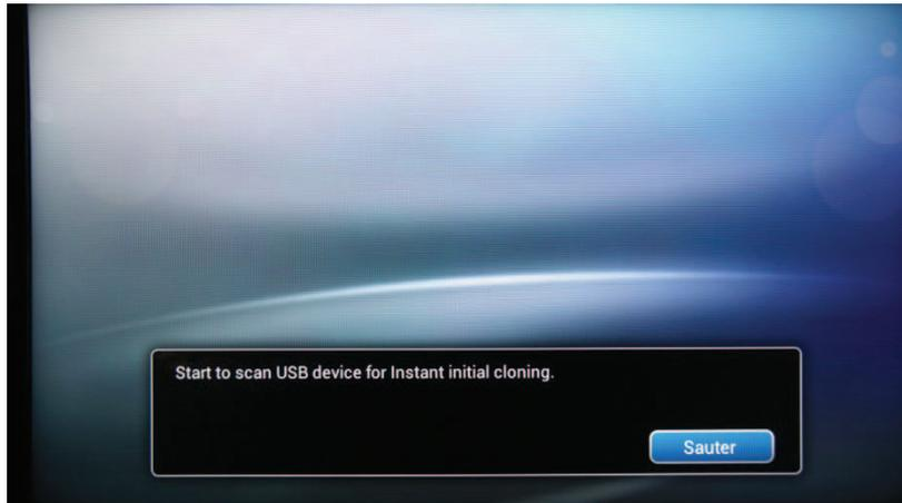
Le téléviseur indique qu'une recherche est en cours pour le clonage des données sur clé USB. S'il n'y a pas de données de clonage disponibles, la recherche peut être ignorée. Si le téléviseur ne trouve pas de données à cloner, l'assistant d'installation passe à l'étape suivante
