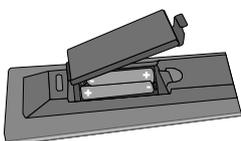
Retirez le couvercle pour ouvrir le logement de piles et veillez à placer les piles dans le bon sens. Les piles adéquates sont AAA, IEC R03 1,5V.
