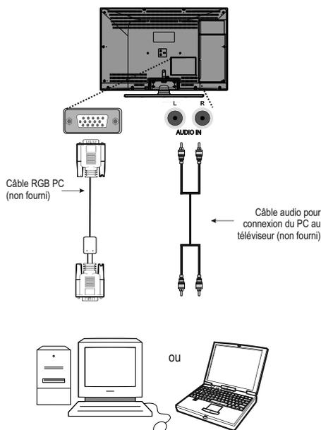
Pour utiliser un PC, réglez la résolution de sortie du moniteur de l'ordinateur avant de le raccorder au téléviseur. Pour afficher une image optimale, utilisez la fonction Réglage PC.
