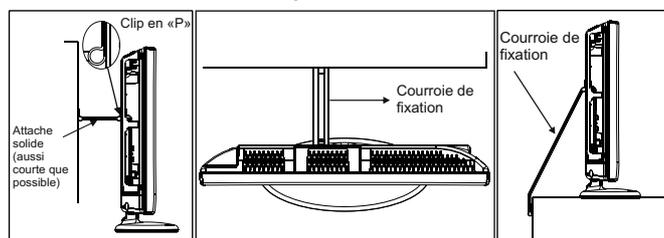
La position de clip en « P » du téléviseur dépend du modèle
