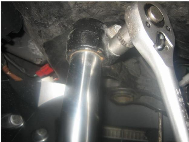
Une fois le fourreau dans les mains, a l'aide d'un étau, il faut débloquer le bouchon de remplissage qui ce trouve au dessus de ce dernier , mais il faut une clé 6 pans mal de 17 que je ne dispose pas et mon concessionnaire non plus, âpres plusieurs essais, j'ai utilisé une clé a pipe débouché de 12 facom qui fait 17 a l'extérieur.
