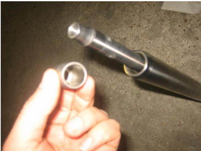
Remettre la vis sous le fourreau avec le joint cuivre.
