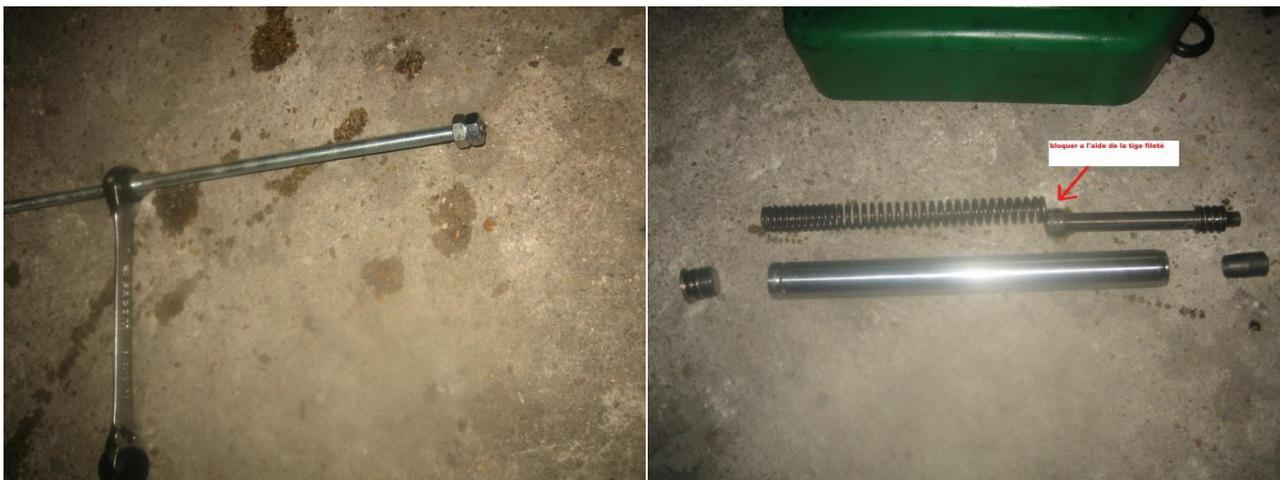
Maintenant sur la partie grise vu de dessus, il y'a le cache poussière, il faut le retirer avec un tournevis plat ( tout doucement pour ne pas abimer) une fois retiré, encore un autre joint ; le joint spy c'est lui qui fait l'étanchéité entre les deux parties, il faut aussi le retirer délicatement aussi avec un gros tournevis plat « pour moi le plus dure a faire sur cette réparation »
