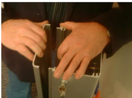
Appuyez sur les côtés du poteau pour détacher la porte de maintenance en la tirant vers l'avant.
