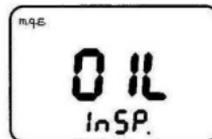
Une fois atteint le kilométrage indiqué pour le contrôle, au démarrage suivant la page représentée sur la figure ci-contre s'affiche et reste visualisée tant que le véhicule est à l'arrêt.
