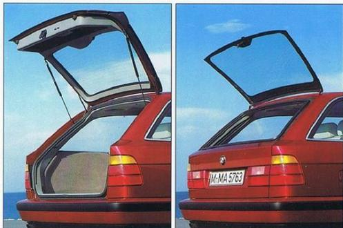
*Die Scheibe in der Heckklappe läßt sich separat nach oben öffnen.*
