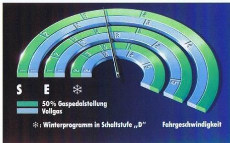
*BMW Automatic mit EH-Steuerung: Sie bestimmen das Fahrprogramm, die Elektronik errechnet die Schaltzeitpunkte und die Hydraulik schaltet. In der Grafik sind für die drei Fahrprogramme S, E und \* schematisch die jeweiligen Hochschaltzeitpunkte über der Fahrgeschwindigkeit aufgetragen, und zwar beispielhaft für 50% Gaspedalstellung (grün) und Vollgas (blau).*
