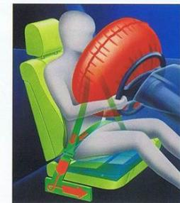
Klassenlose Sicherheit: Der bei allen BMW serienmäßige Fahrer-Airbag bietet zusammen mit dem angelegten Sicherheitsgurt mit Gurt-schloßstrammer und der Submarining-Stütze optimalen Schutz bei einem Frontalaufprall. Innerhalb von Hundertstelsekunden füllt sich der Luftsack und fängt Kopf und Oberkörper auf.
