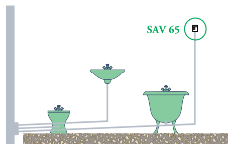
Exemple d'utilisation de clapet aérateur de petit diamètre posé en bout d'une canalisation de grande longueur.
