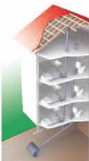
Exemple d'utilisation de clapet aérateur de gros diamètre.
