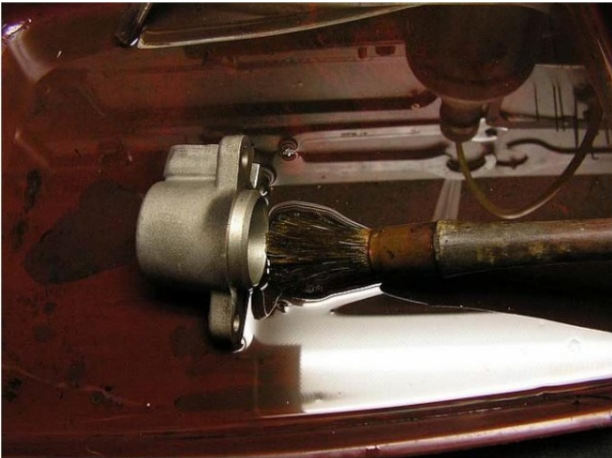
Terminer en passant très légèrement du papier abrasif 1000 à l'intérieur, en lubrifiant avec de l'huile et terminer avec un peu de laine de fer 000
