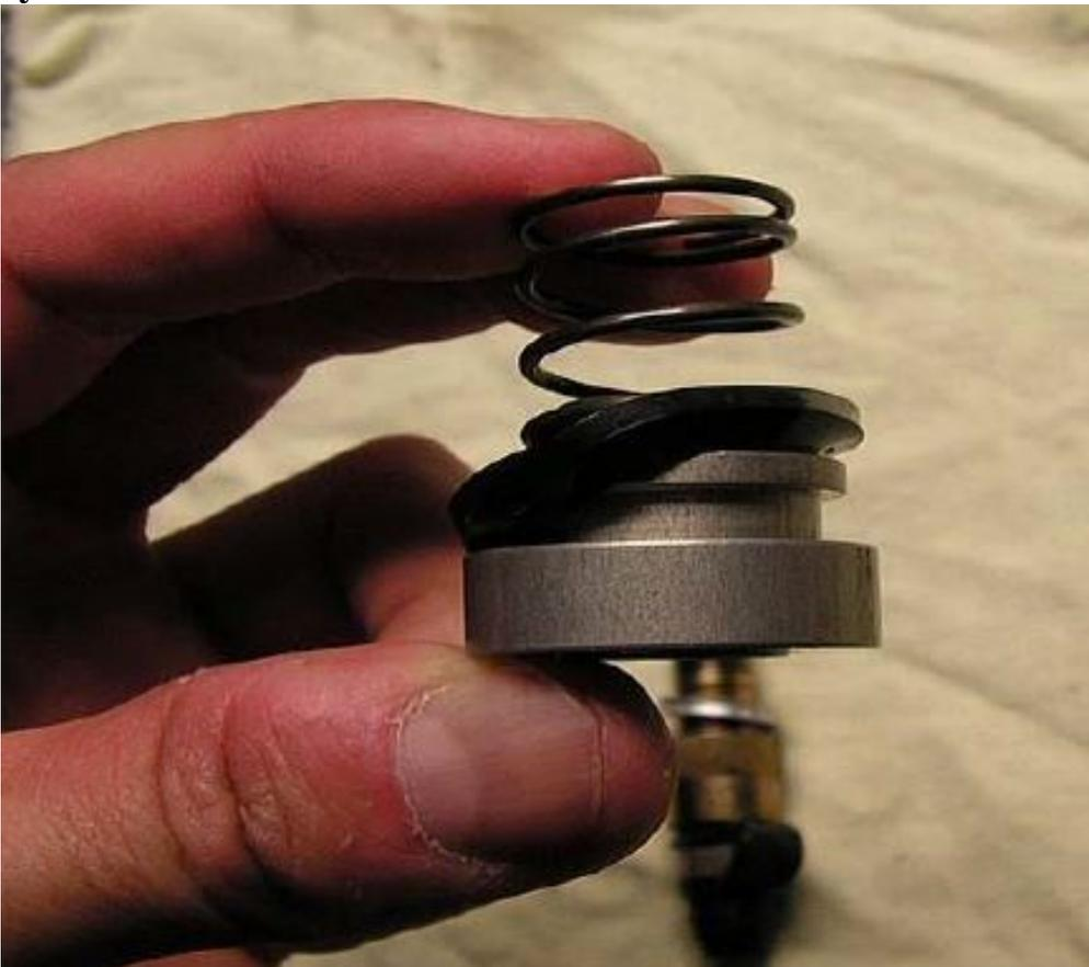
Remonter le tout en prenant soin de remplacer les deux joints de l'ensemble raccord-vis de purge
