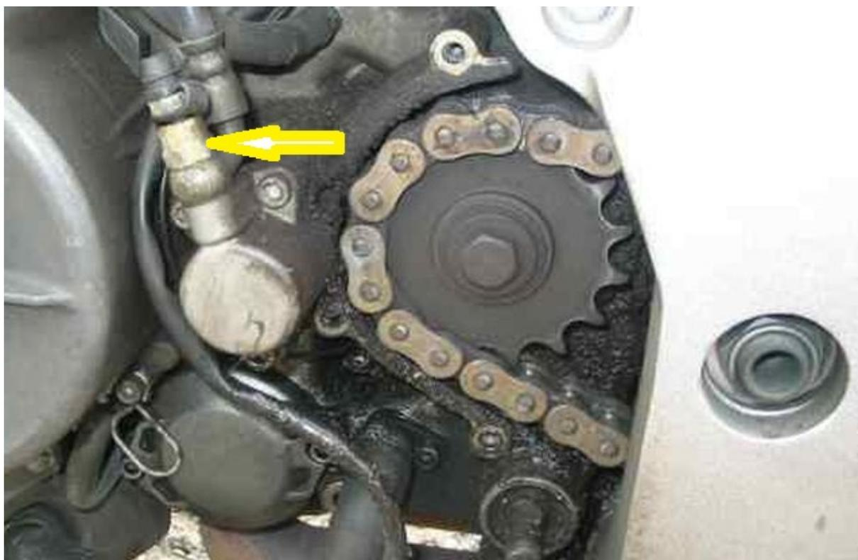
Dévisser les 3 vis de fixation du cylindre => clé BTR de 5
