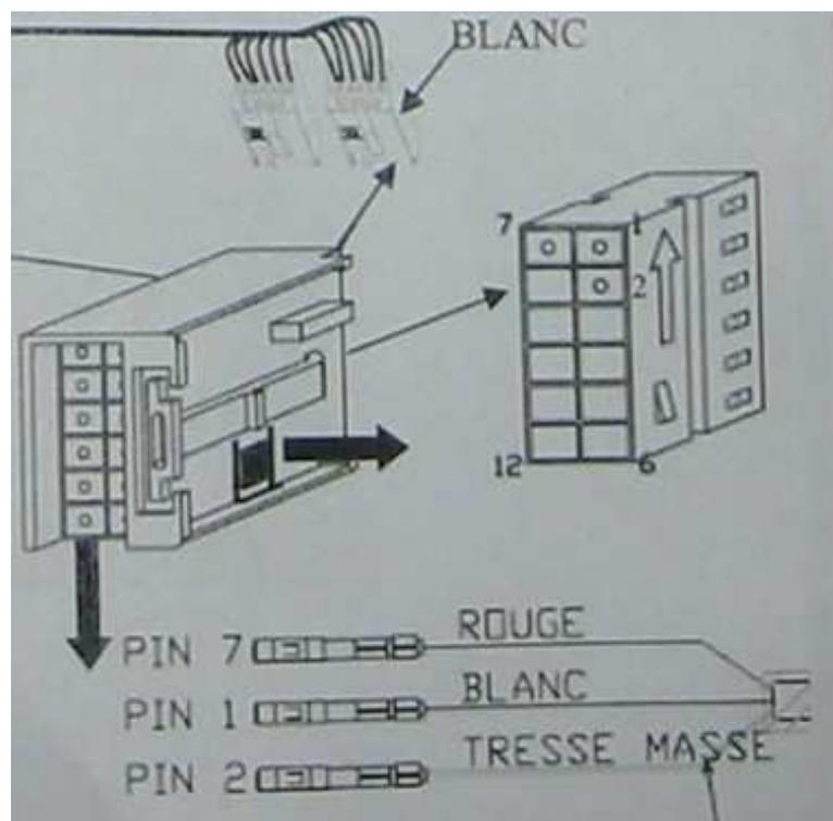
Le branchement du câble jack se fera sur la prise blanche comme indiqué sur le schéma. Après avoir mis en place les 3 fiches dans la prise, il suffit de rebrancher et de remonter l'autoradio.
