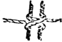
( الرند ) تستعمل هذه العقدة لربط المضارب بالارناد ونصب الجسور والابراج
