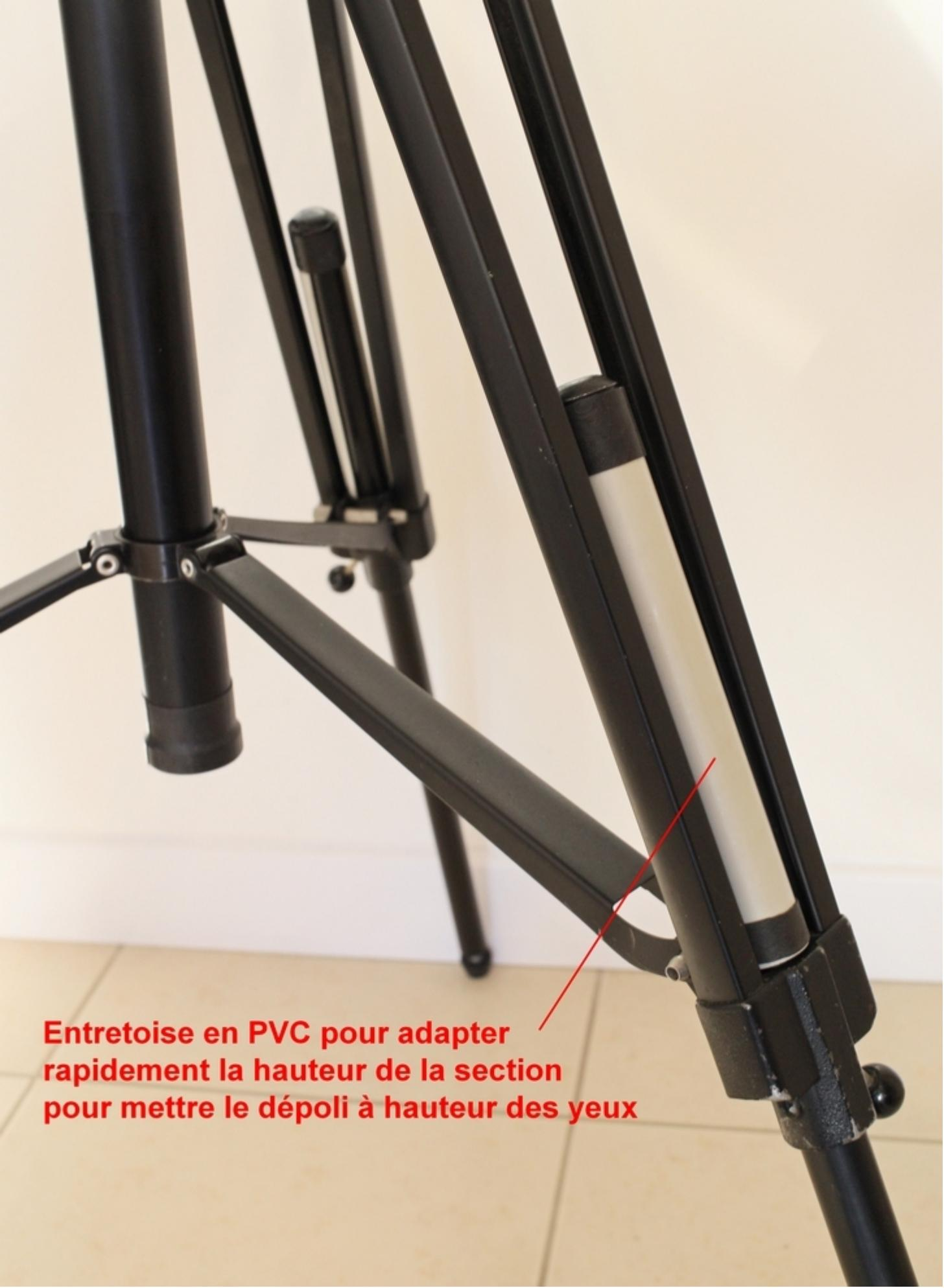
**Entretoise en PVC pour adapter rapidement la hauteur de la section pour mettre le dépoli à hauteur des yeux**
