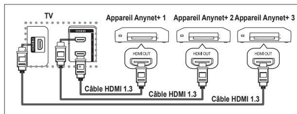
A l'aide du câble HDMI, reliez la prise [HDMI 1], [HDMI 2] ou [HDMI 3] du téléviseur à la prise HDMI OUT de l'appareil Anynet+ correspondant.
