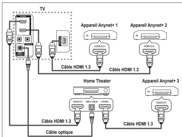
1. A l'aide du câble HDMI, reliez la prise [HDMI 1], [HDMI 2] ou [HDMI 3] du téléviseur à la prise HDMI OUT de l'appareil Anynet+ correspondant.
