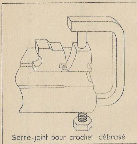
**Voir paragraphe :** Ressouder solidement et proprement un crochet débrasé.
