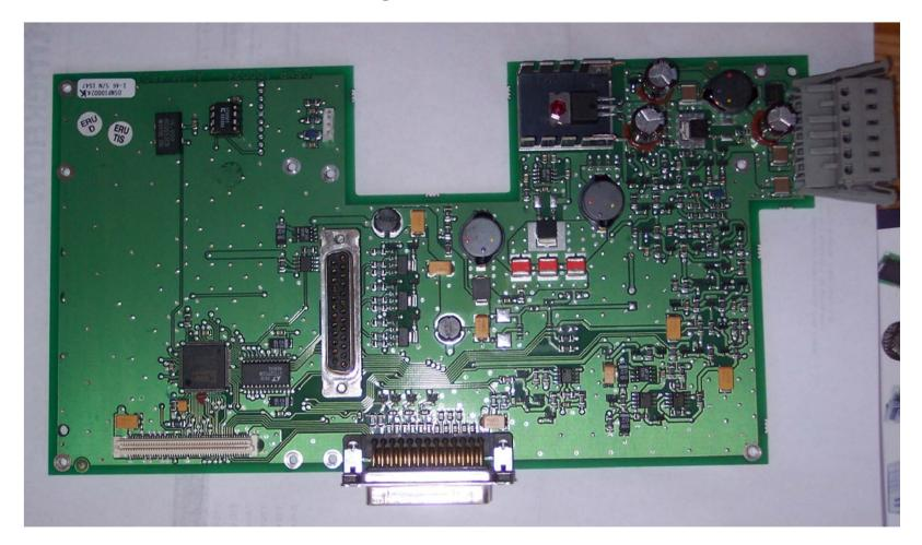
Recup pas grand chose a part capas CMS ,selfs de puissance, LTC12771, oscillateur 16 Mhz, pic 17S05PI reste le boitier qui est assez sympa!
