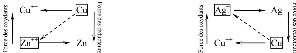
L'analyse de ces deux schémas montre que la première réaction n'est pas possible puisque les produits de la réaction (Zn et  $\text{Cu}^{++}$ ) sont plus forts que les réactifs (Cu et  $\text{Zn}^{++}$ ).
