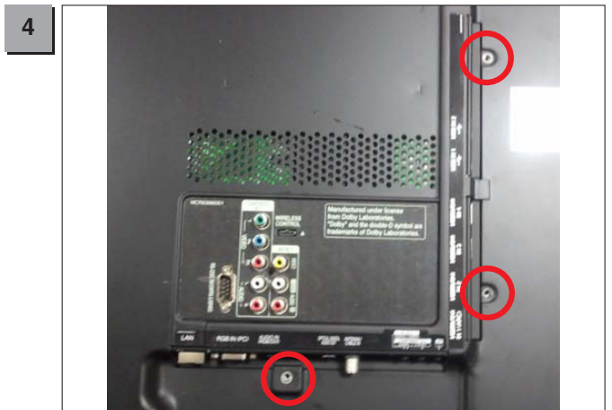
Disassemble 3 screws that fix Side AV bracket and Back cover.
