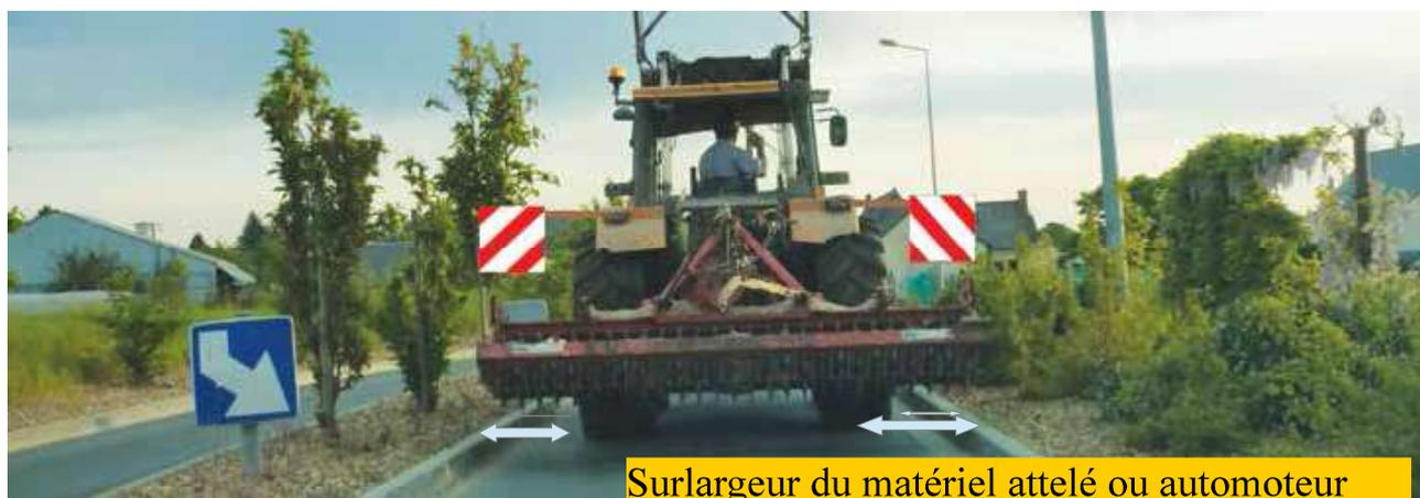
Le mobilier urbain doit être implanté suffisamment en retrait du bord de chaussée pour permettre le passage des matériels agricoles larges ou déportés. Ce retrait peut être également géré sur la chaussée en traitant une surlargeur de manière différenciée (couleur, matériaux). Lorsque le mobilier urbain est installé de part et d'autre de la voie, opter pour un positionnement en décalé.
