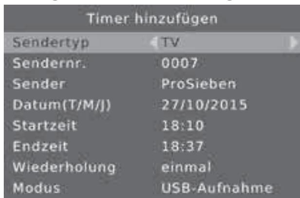
Si vous appuyez sur le bouton **OK** dans la vue du guide électronique des programmes après avoir choisi un programme, ce dernier est repris dans la programmation d'enregistrement. Des informations telles que la chaîne, la date et l'heure sont reprises automatiquement à partir du guide électronique des programmes.
