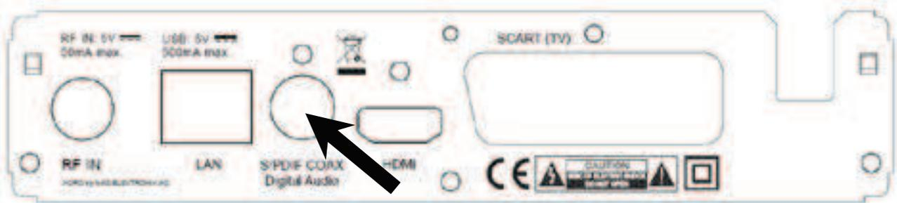
La connexion numérique à un système HiFi requiert un câble coaxial pour les signaux S/PDIF. Ce câble n'est pas inclus dans le contenu de livraison du récepteur. Reliez la sortie **S/PDIF** à une entrée S/PDIF sur votre système HiFi. Recherchez dans le mode d'emploi du système HiFi comment activer l'entrée audio.
