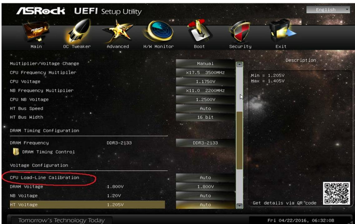
Puis on va augmenter de 100 mhz le ratio, booter sous windows et faire 30 min d'OCCT et contrôler les températures.
