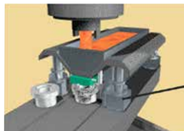
Quatre vérins RSJA de SKF sont utilisés pour le positionnement en hauteur d'une poche de coulée continue dans le secteur sidérurgique.
