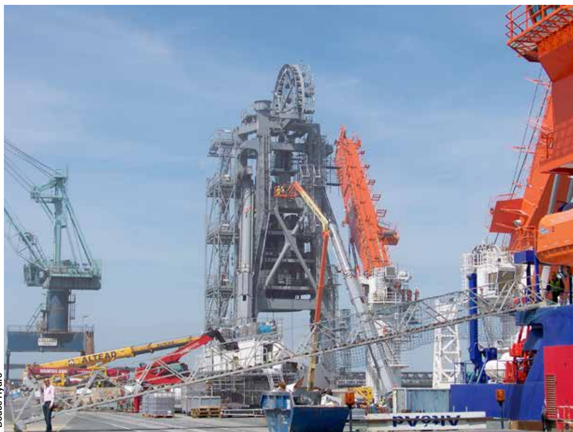
Douce Hydro vient de fournir deux vérins poussant 200 tonnes sur près de 13 mètres de course destinés à l'inclinaison d'une tour montée sur un navire utilisé pour la dépose de pipelines sous-marins.
