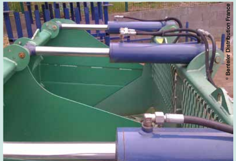
Roulés soudés ré-étirés selon la norme EN 10305-2, les tubes présentent une excellente géométrie et un état de surface extérieur offrant un meilleur rendu après peinture.
