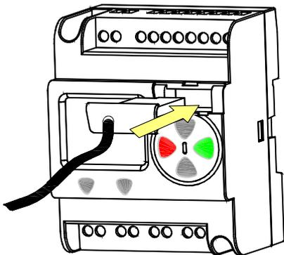
3 - Marche à suivre pour débrancher le module Câble de Programmation.
