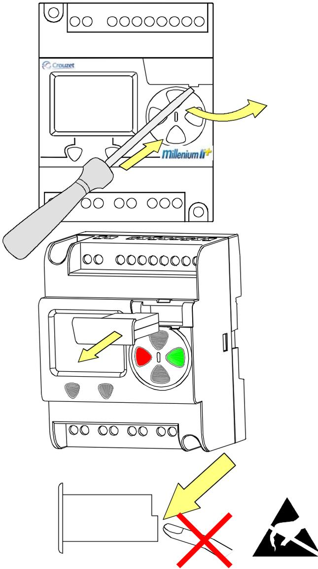
2 - Marche à suivre pour raccorder le module Câble de Programmation.
