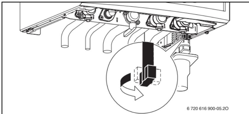
Fig. 6 Robinet de remplissage (appareils NGVA/NGLA/CGVA/CGLA)
