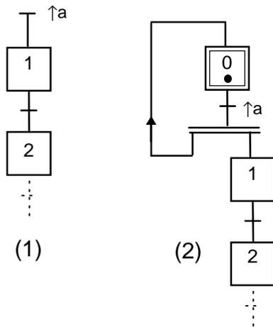
EXEMPLE : Transition source et structure équivalente :
