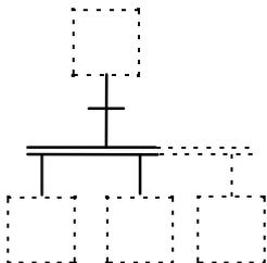
Le symbole N° 18 de synchronisation est utilisé dans cette structure pour indiquer l'activation simultanée de plusieurs séquences à partir d'une ou plusieurs étapes.
