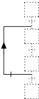
Cas particulier de sélection de séquences, qui permet de recommencer la même séquence jusqu'à ce que, par exemple, une condition fixée soit obtenue.
