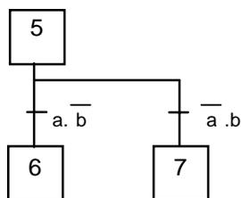
EXEMPLE 1 : L'exclusion entre les séquences est obtenue par l'exclusion logique des deux réceptivités, si a et b sont simultanément vraies lorsque l'étape 5 est active, aucune des transitions n'est franchissable.
