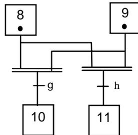
EXEMPLE 3 : Sélection de séquences à partir d'une synchronisation de deux séquences amonts.
