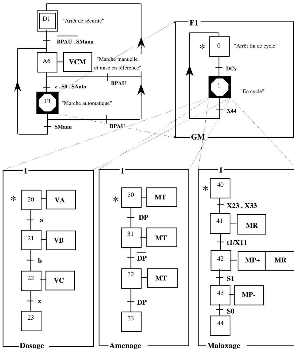
**Figure B6 - Structuration selon les modes de marche utilisant des étapes encapsulantes :**
