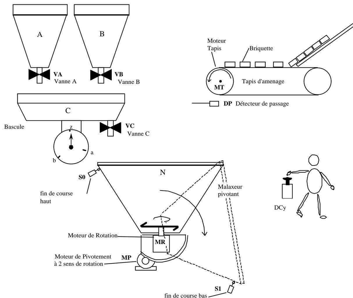
Figure B1 - Représentation schématique du doseur malaxeur
