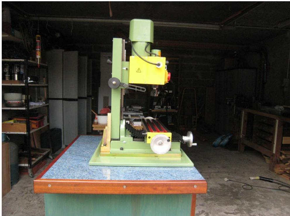
Bien que je n'utilise pas cette possibilité, il est toujours possible d'incliner la colonne verticale. Il suffit pour cela d'enlever les 4 vis M10 vissées dans la colonne.
