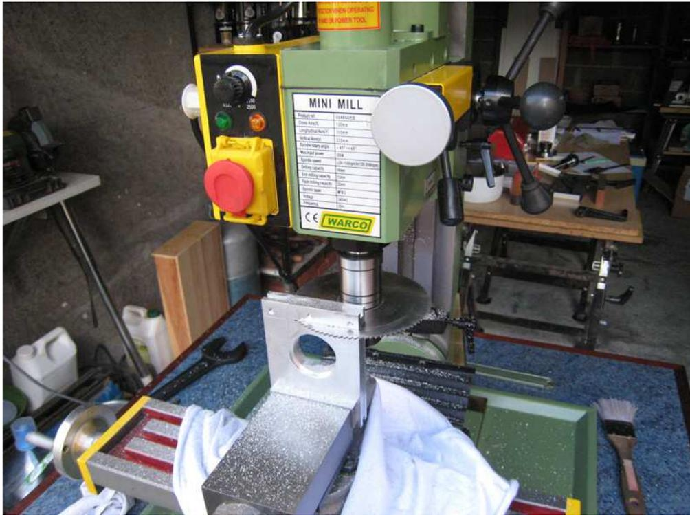
On trouve sur le marché plusieurs familles de fraiseuses X2. Le moteur de nos machines est plus puissant mais il me semble que les engrenages de la machine à moteur moins puissant ont été conservés.
