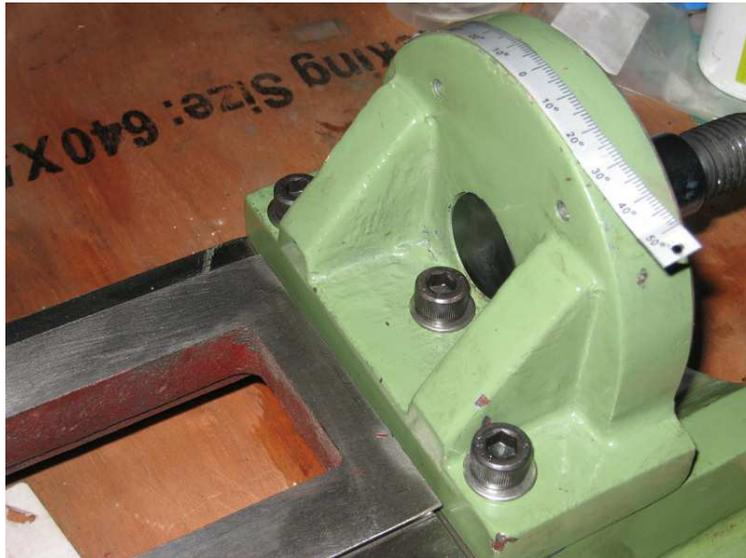
Je l'ai remplacée et fixée avec des vis inox :
