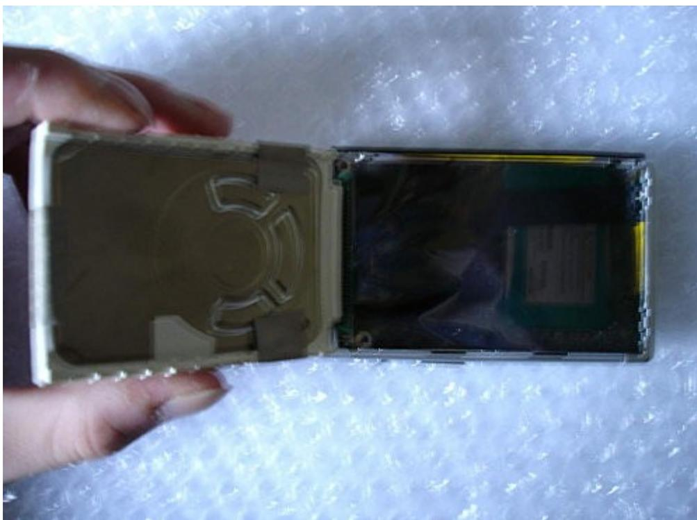
Débrancher le disque dur est assez facile: Tenez le disque dur d'une main (la gauche par exemple), puis tirer délicatement le disque dur en arrière en maintenant les pattes symbolisées par les flèches vertes. Vous pouvez aussi passer un petit outil entre les pattes et le connecteur du disque dur de chaque côté pour le déconnecter.
