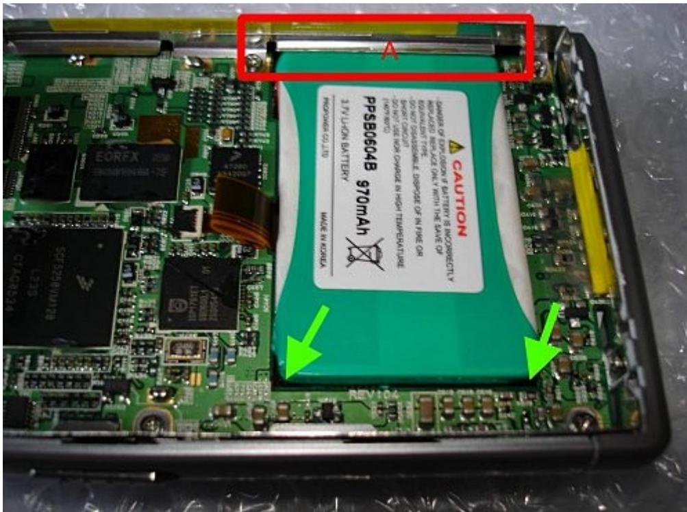
Lorsque la batterie est définitivement calée, remplacez la feuille protectrice antistatique que vous aviez retiré et mis de coté tout à l'heure, puis reconnectez le disque dur (dans le bon sens) et placez le berceau dans son emplacement d'origine.
