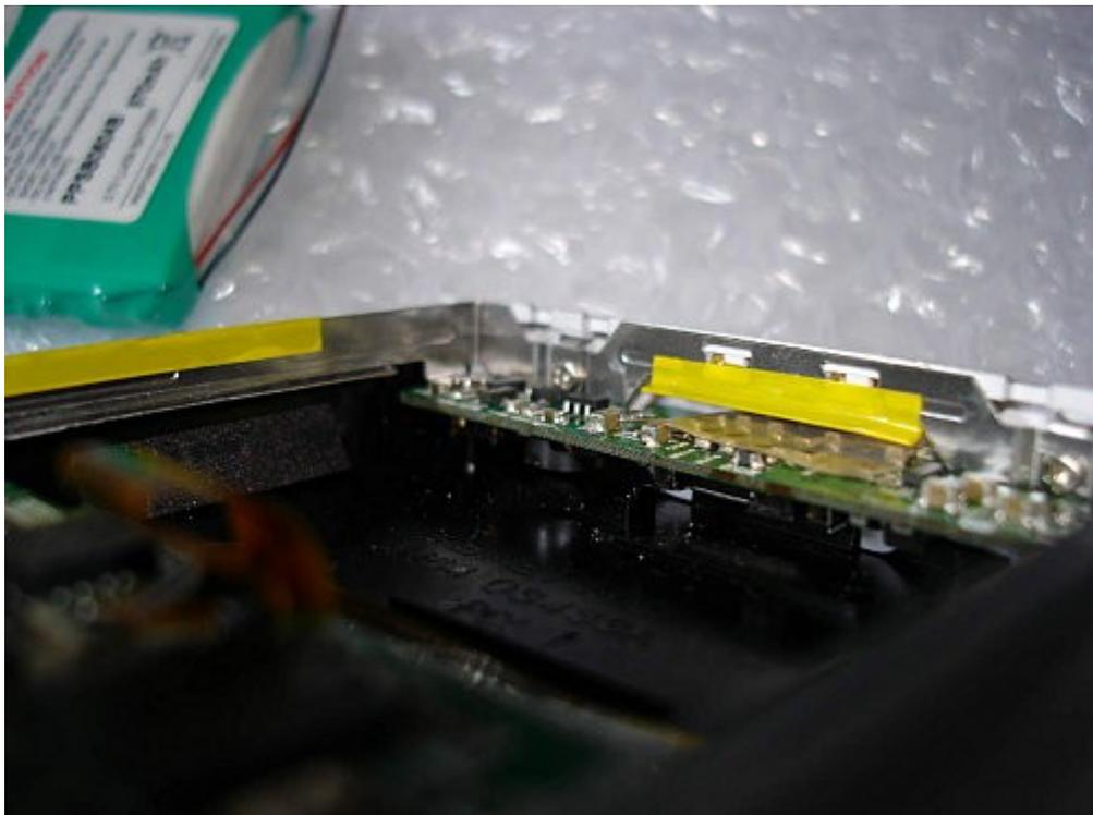
La batterie est déconnectée et retirée. Remarquez la nappe pour les touches en façade. Mettez l'ancienne batterie de côté et préparez la nouvelle batterie.
