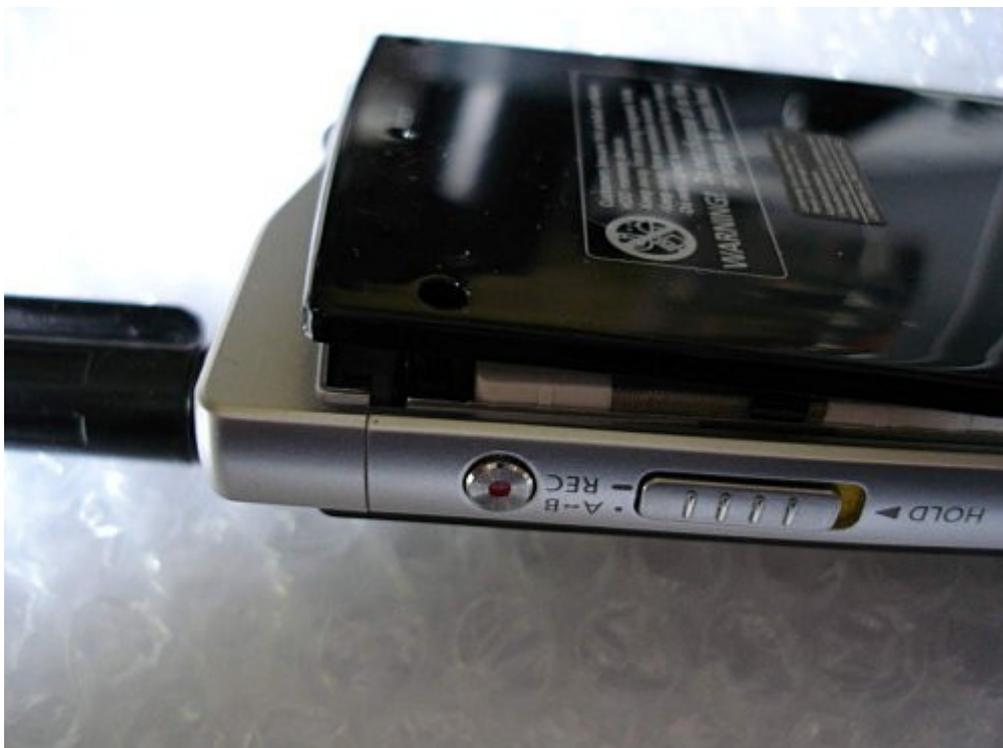
Le panneau arrière est maintenant retiré. Notez que dans mon cas, les petites vis sont restées sur le panneau arrière. Ne perdez pas les vis en manœuvrant le panneau arrière.
