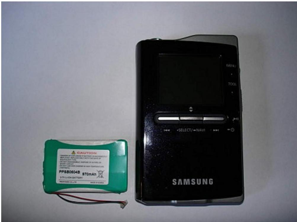
La batterie est plutôt petite et son dispositif de connexion parait fragile. Ne retirez surtout pas la partie verte sur laquelle se trouve l'étiquette de la batterie! Elle cache un petit dispositif pour la régulation de la tension d'alimentation.
