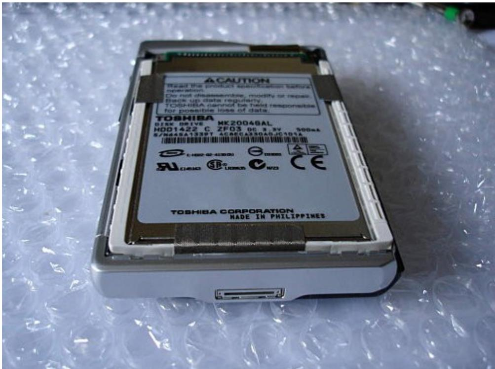
Soulevez la partie inférieure du berceau avec un petit tournevis (sans forcer) et vous pourrez le dégager facilement. Attention à ne pas tirer dessus car il est encore relié à l'appareil par son connecteur.
