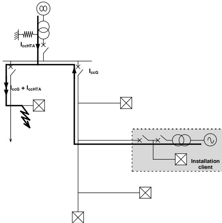
Dans le cas d'un défaut jeu de barres, la diminution des courants de défaut vus par la protection est négligeable et ne remet pas en cause son réglage. Par contre, la diminution des courants de défaut vus par la protection en cas de défaut sur un départ, se traduit par une réduction de sa sensibilité à réglage constant et diminue la zone couverte par la protection arrivée en cas de défaillance de la protection départ.
