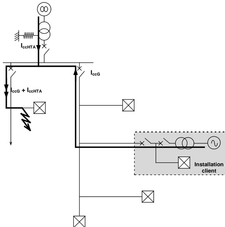
Ce courant peut dépasser le seuil de la protection à maximum de courant de phase du départ de raccordement et provoquer le fonctionnement intempestif de cette protection entraînant une panne de l'alimentation des utilisateurs du départ.
