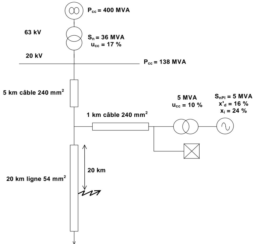
1) La centrale est couplée au réseau HTA et contribue à l'alimentation du courant de défaut avec le réseau amont :
