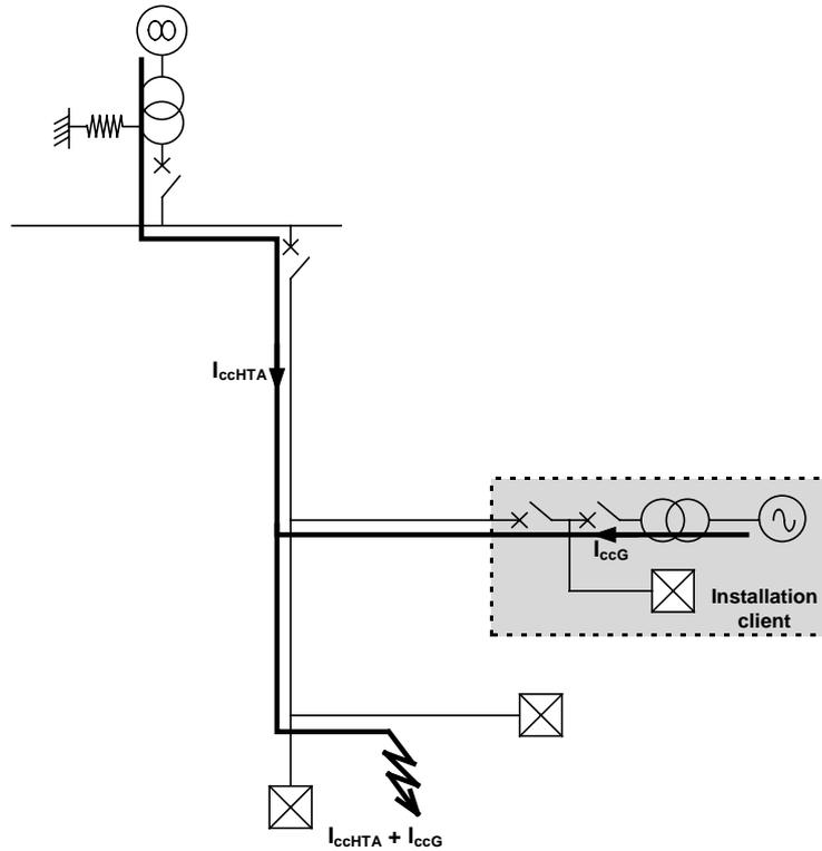
La diminution des courants de défaut vus par la protection du départ se traduit par une réduction de sensibilité à réglage constant. Dans le cas extrême, les courants de défaut peuvent être réduits au niveau du courant de charge, la protection à maximum de courant de phase est alors en situation de risque d'aveuglement.
