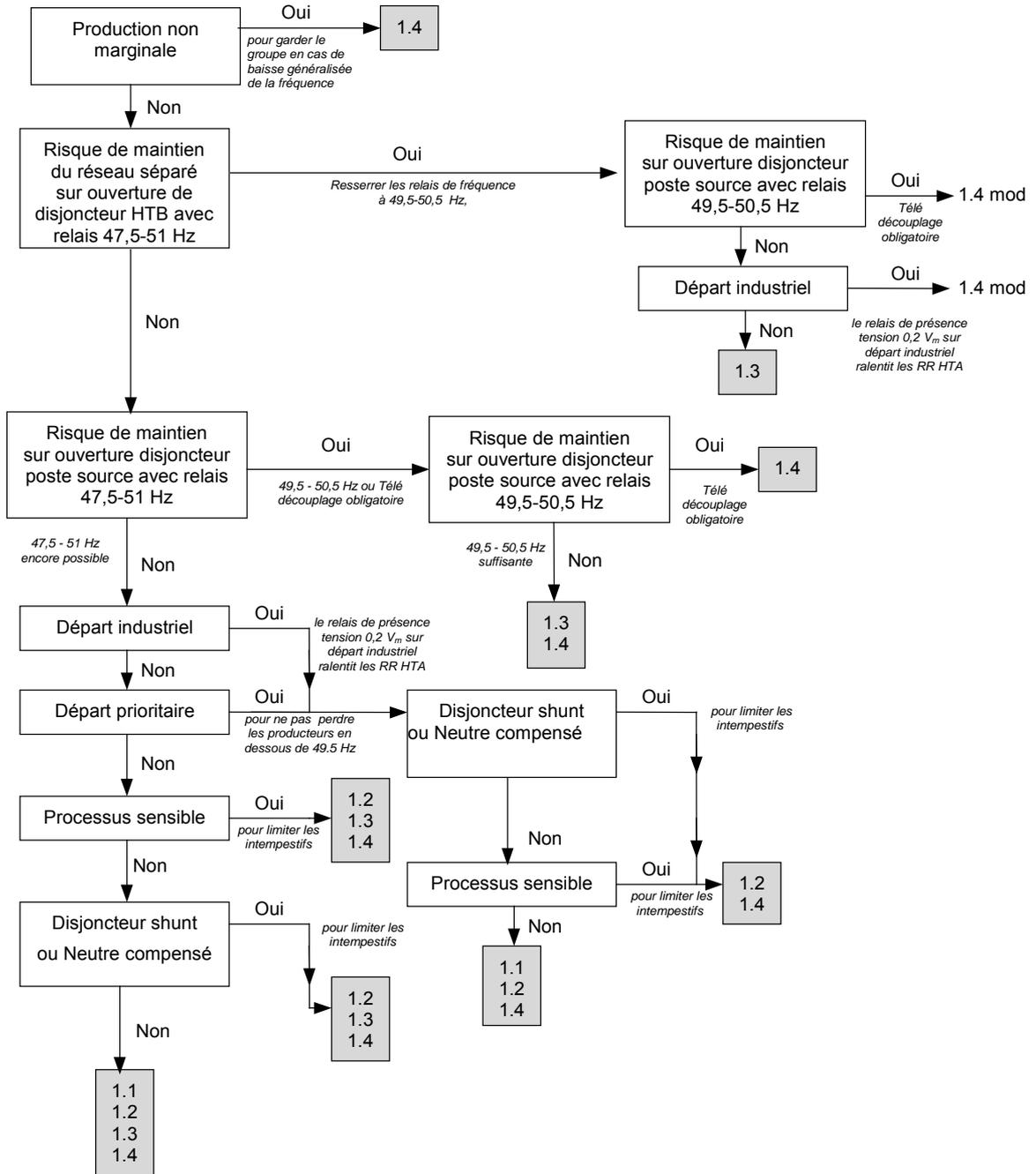
La protection de type 1.4 est souhaitable pour une centrale non marginale car on souhaite un découplage rapide sans risque de découplage injustifié et conserver la production en cas de baisse généralisée de la fréquence.
