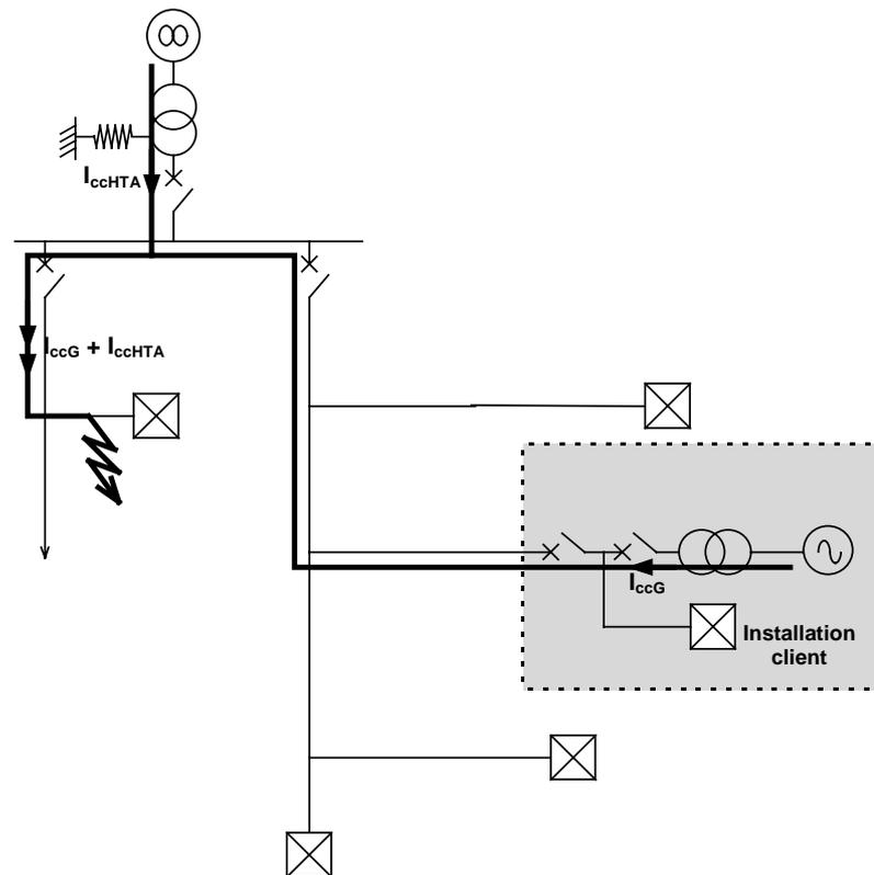
Ce courant peut dépasser le seuil de la protection à maximum de courant de phase et provoquer le fonctionnement intempestif de cette protection et la coupure d'alimentation électrique d'une partie ou la totalité de l'installation du client.
