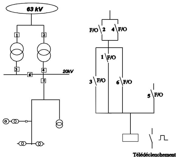
La formation de l'ordre télé découplage doit être assurée même en cas de consignation d'un des organes. L'utilisation des ordres sortis par les protections de départ, de transformateur et de masse tableau est à éviter, sa réalisation étant plus compliquée et présentant une moindre fiabilité.
