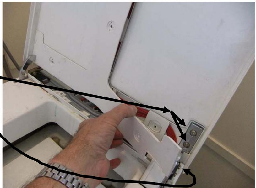
La charnière à remplacer peut maintenant être enlevée, la nouvelle remplacée.
