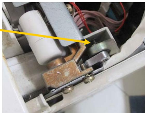
3/ Enlever les 2 vis de la partie arrière de la charnière qui se trouvent sur la pièce métallique transversale.
