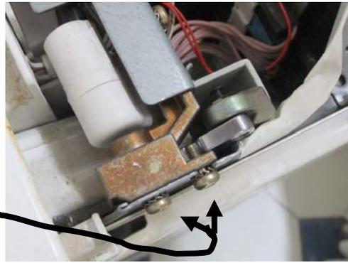
5/ Soulever le couvercle. Enlever les 3 pastilles plastique qui cachent les vis de fixation du protège câbles en plastique, avec une pointe ou un petit tournevis (le protège-câbles a une forme en T renversé)
