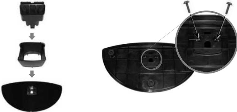
2. Legen Sie den TV mit dem Bildschirm nach unten auf einen Tisch mit einer weichen Stoff- oder Schaumstoffunterlage und stecken Sie den zusammengebauten Standfuß in die dafür vorgesehene Metallplatte.
