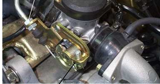
Vis de réglage du ralenti
