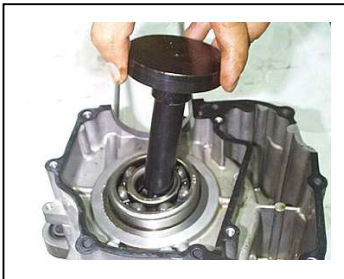
Poser le roulement de carter gauche
