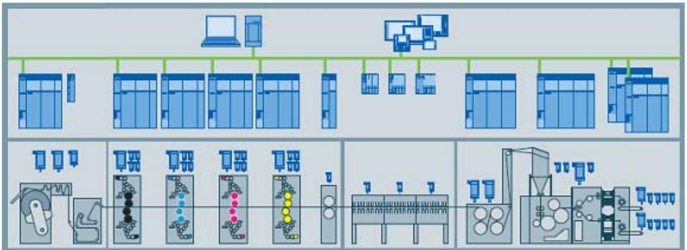
Figure 158 Schéma synoptique de la ligne d'impression (Document Siemens)
