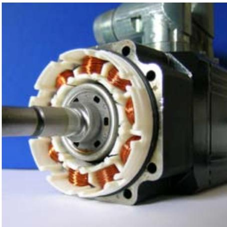
Figure 40 Vue interne d'un servomoteur synchrone
