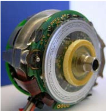
Figure 63 Disque optique d'un codeur incrémental
