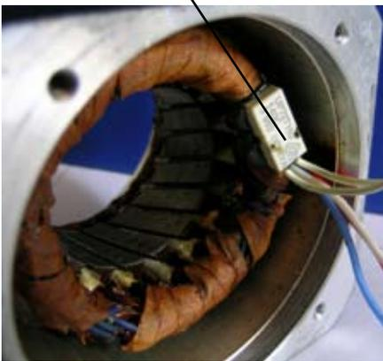
Figure 43 Inclinaison des bobinages du stator d'un servomoteur
