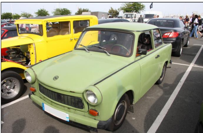
TRABANT 601 construite de 1963 à 1990 et son moteur 2cyl. 2temps. Réservoir de 26 litres.
